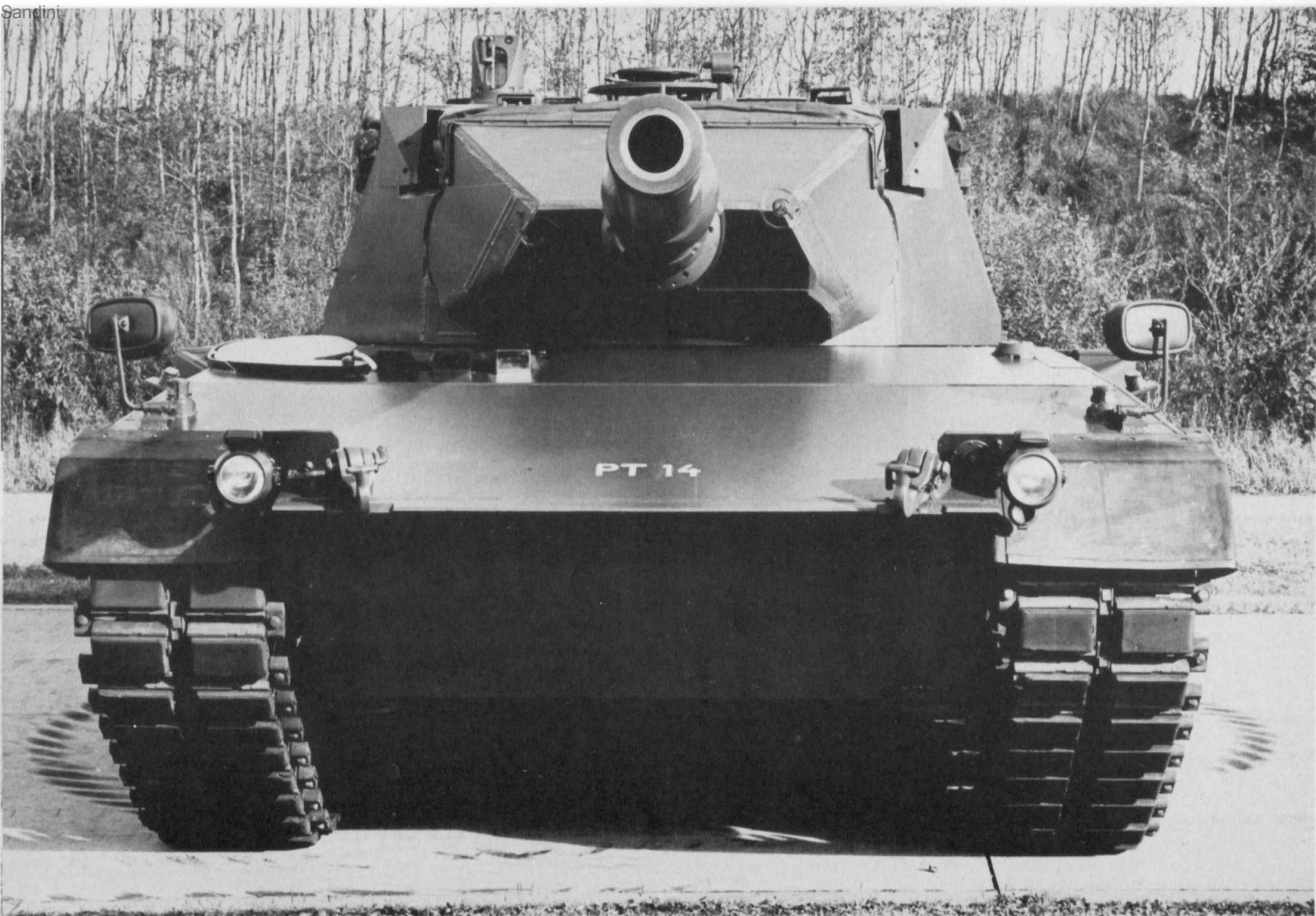
Der Prototyp PT 14 – frisch vom Montageband – mit Basisentfernungsg r t und 120 mm Glattrohrkanone
