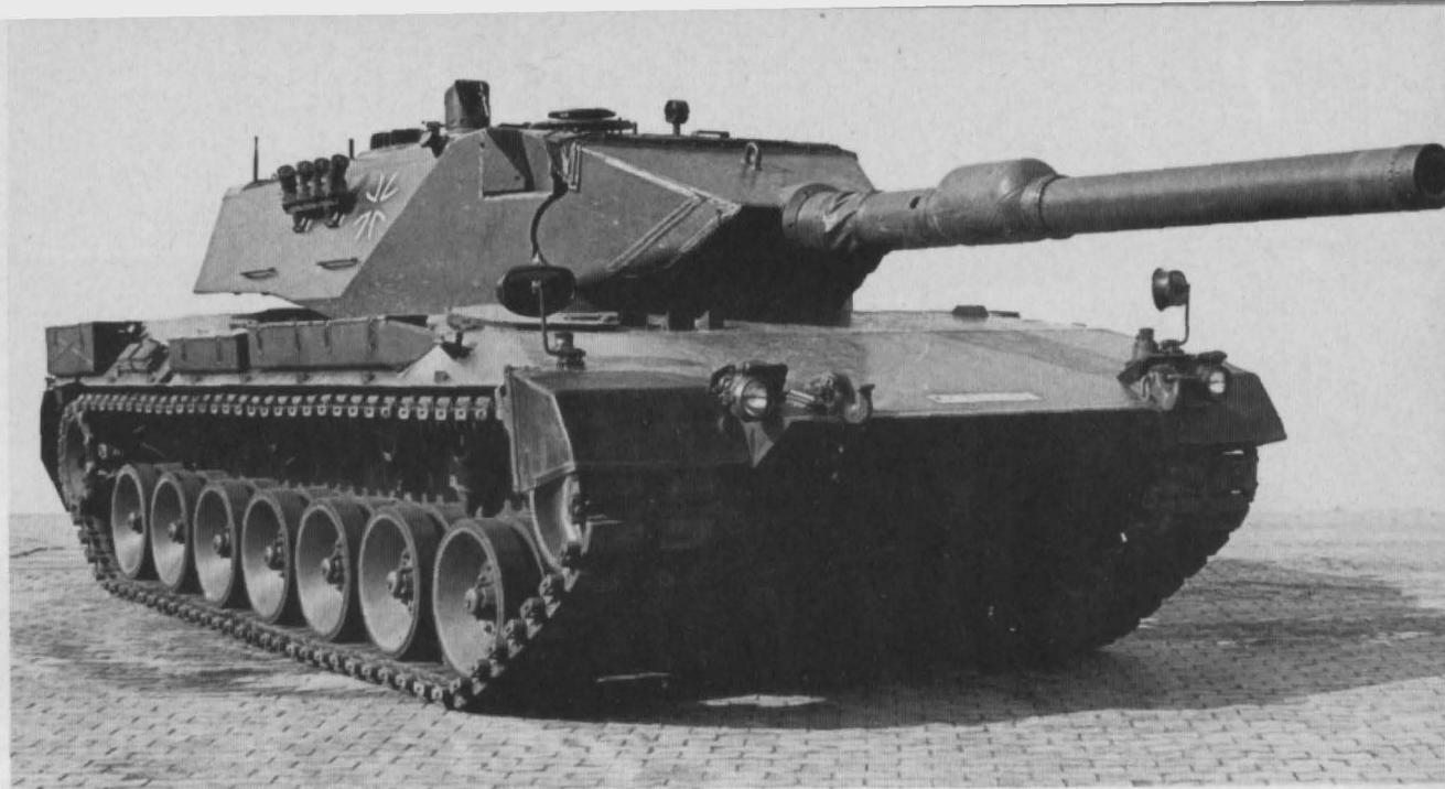
Der Prototyp mit der 120 mm Glattrohrkanone ...
