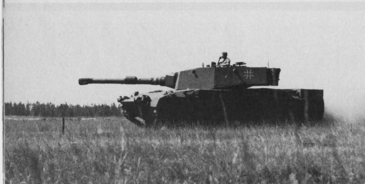
Der Kampfpanzer Prototyp Turm 14 (T 14 mod.) wurde gleichzeitig zum PT 19/T19-AV gebaut. Während der PT 19/T19-AV zur Vergleichserprobung KPz Leop 2/KPz XM 1 in den USA eingesetzt wurde, stand der T 14 mod. für nationale Erprobungen und Versuche zur Verfügung.
