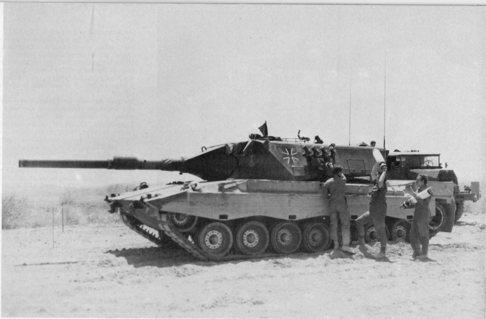
Aufmunitionieren eines der 17 Prototypen mit Munitionssorte KE-120 mm in der Wüste von Arizona bei bis zu + 43° C im Schatten. Im Kampfpanzer wurden teilweise bis zu + 63° C gemessen. (Mai 1975)
