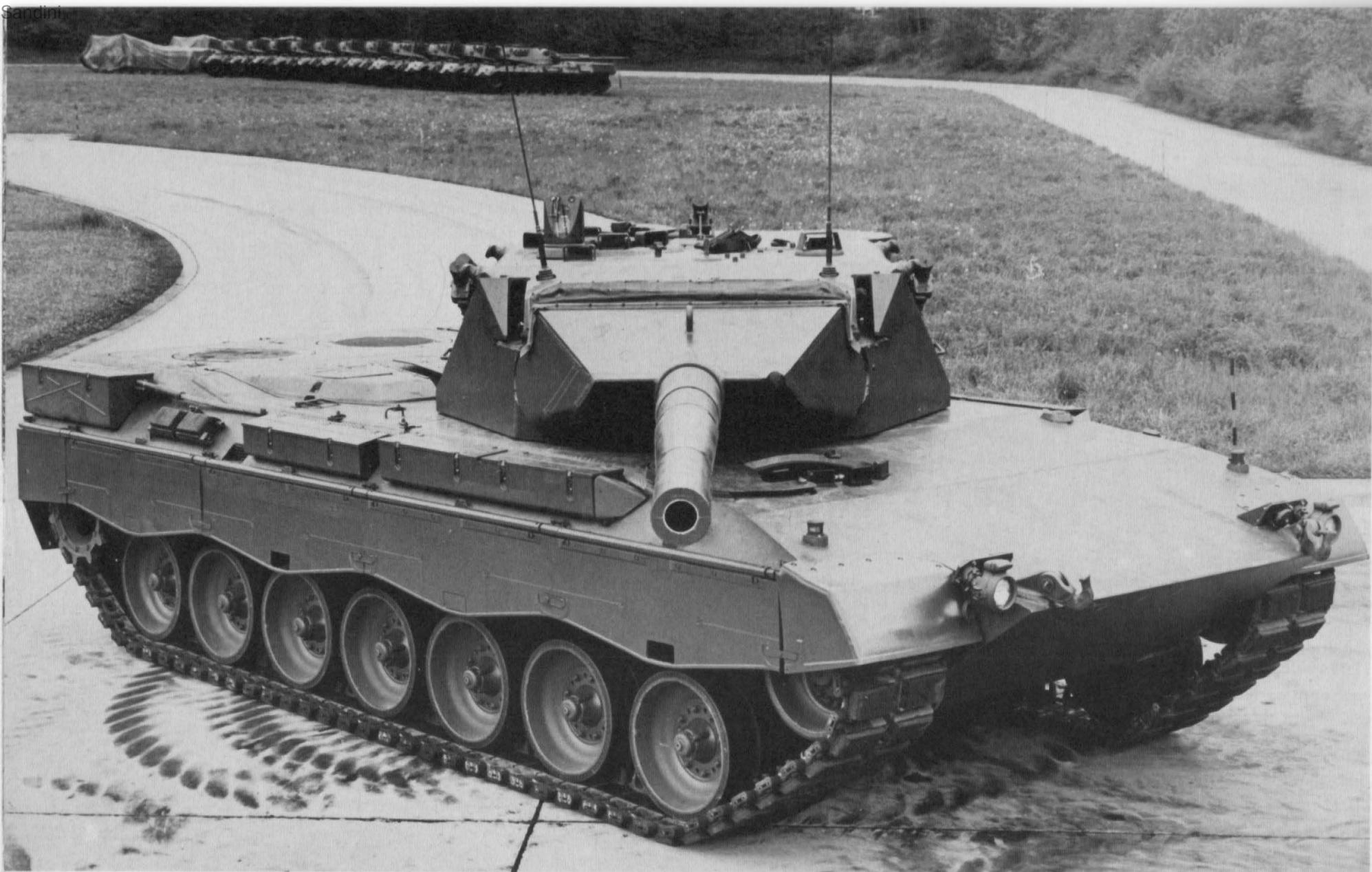
Hier sieht man deutlich die beiden Ausblicke des Basis-Entfernungsmessgerätes an einem Prototyp der ersten Baureihe. Von diesem, den Panzer-
