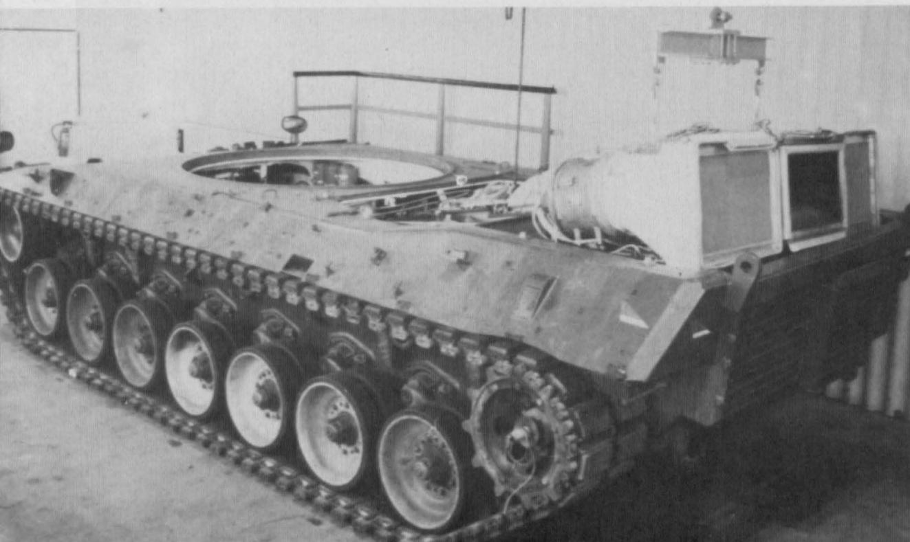
Parallel zu den Erprobungen in den Vereinigten Staaten von Amerika (in Aberdeen/Maryland) wurde bei MAK in Kiel die Gasturbine für den Antrieb des amerikanischen Kampfpanzers XM-1 untersucht
