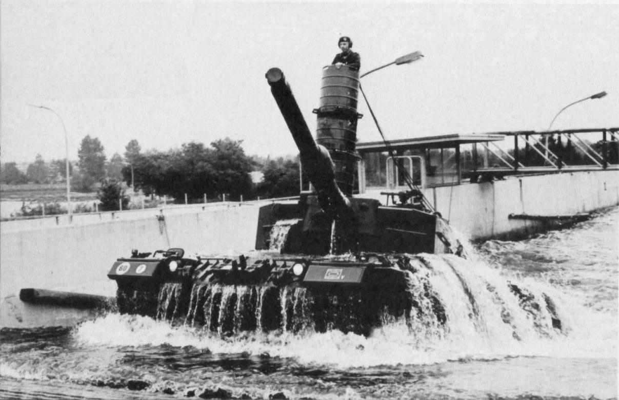
Der Kampfpanzer Leopard ist in der Lage, bis 2,25 Meter tief zu waten und mit Hilfsvorrichtungen Unterwasserfahrten bis zu einer Tiefe von vier Metern durchzuführen
