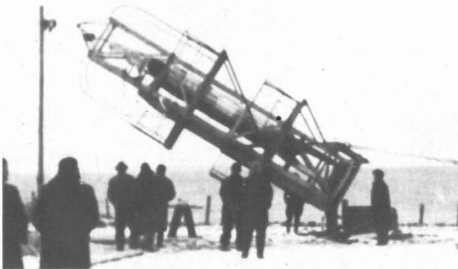
Aufrichten des A 3 mit dem neuen Schwenkgerüst auf der Greifswalder Oie Anfang Dezember 1937. (M)
