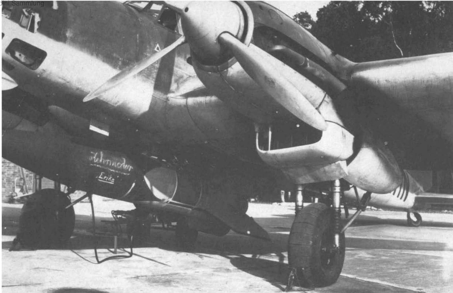
Oben: He 111 mit abwurfbereiten A 5-Modellen aus großer Höhe zur Verbesserung der Pfeil-Stabilität mit Hilfe eingebauter Instrumente, danach mit Fallschirm geborgen, sehr erfolgreiche Tests Dr. Ing. Steinhoffs. (M)
