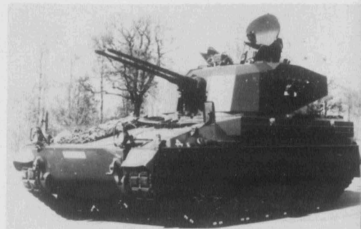
Oben und links: FlaPz DRAGON. Das 678 cm lange Fahrzeug wiegt 31 t und besitzt eine 3-Mann-Besatzung. Der Kommandant erteilt den Feuerbefehl aufgrund der Radarauswertung an den Richtschützen, der das Ziel optisch anvisiert und bekämpft. Das dritte Besatzungsmitglied des DRAGON-Systems ist der Fahrer, sein Platz ist wie beim MARDER vorne links in der Wanne.
