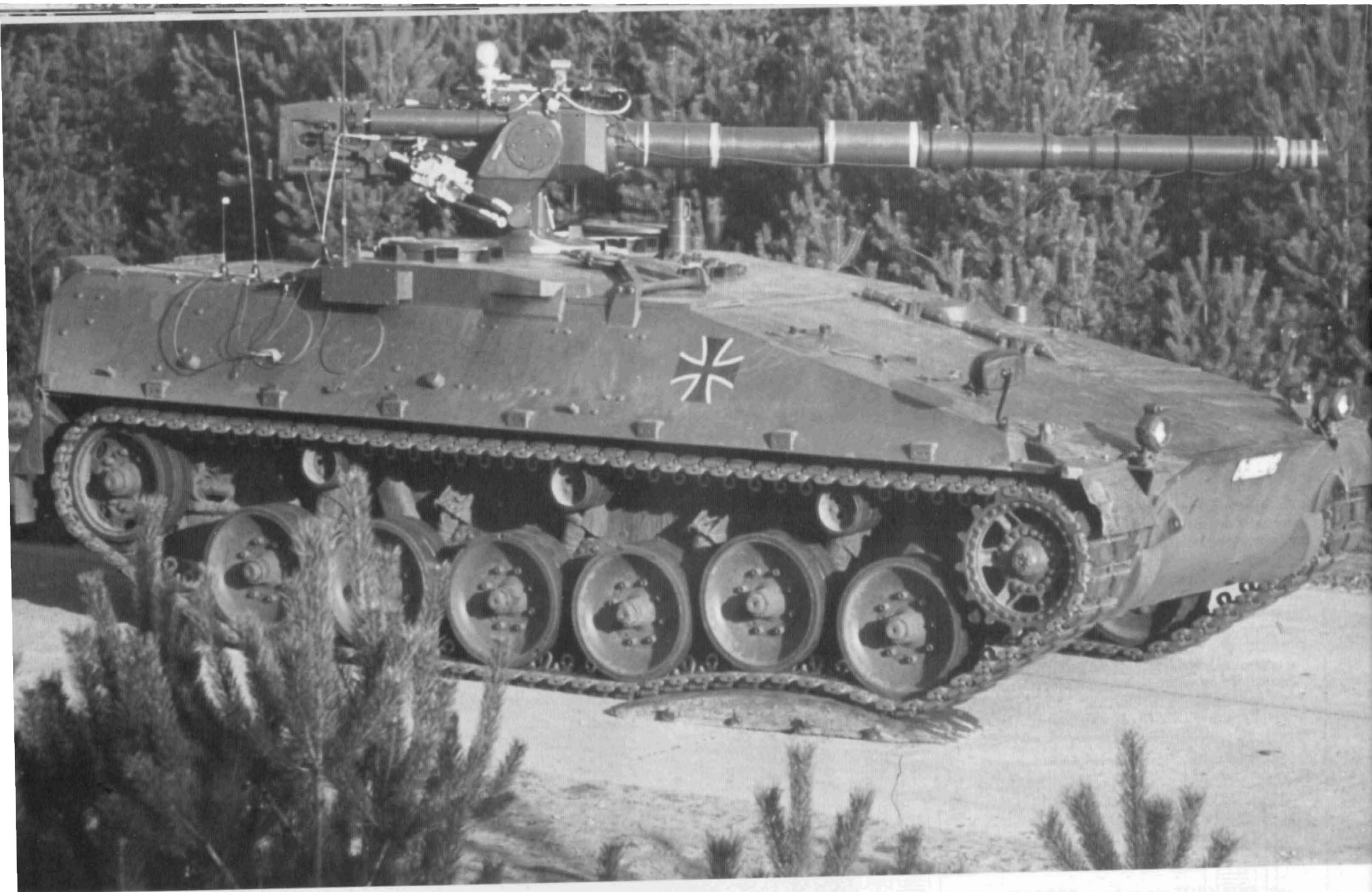
VTS I (Versuchs-Träger-Scheitellafette) mit 105 mm-Kanone. Die günstige Silhouette wird mit dem mangelnden Schutz der Waffenanlage erkauft; der Ladevorgang kann nur durch einen Ladeautomaten ausgeführt werden, die Zieloptiken in der Wanne müssen die Schwenkungen der scheitellafettierten Waffe gleichzeitig vollziehen: Sicherlich lösbare Probleme, doch insgesamt technisch aufwendig.
