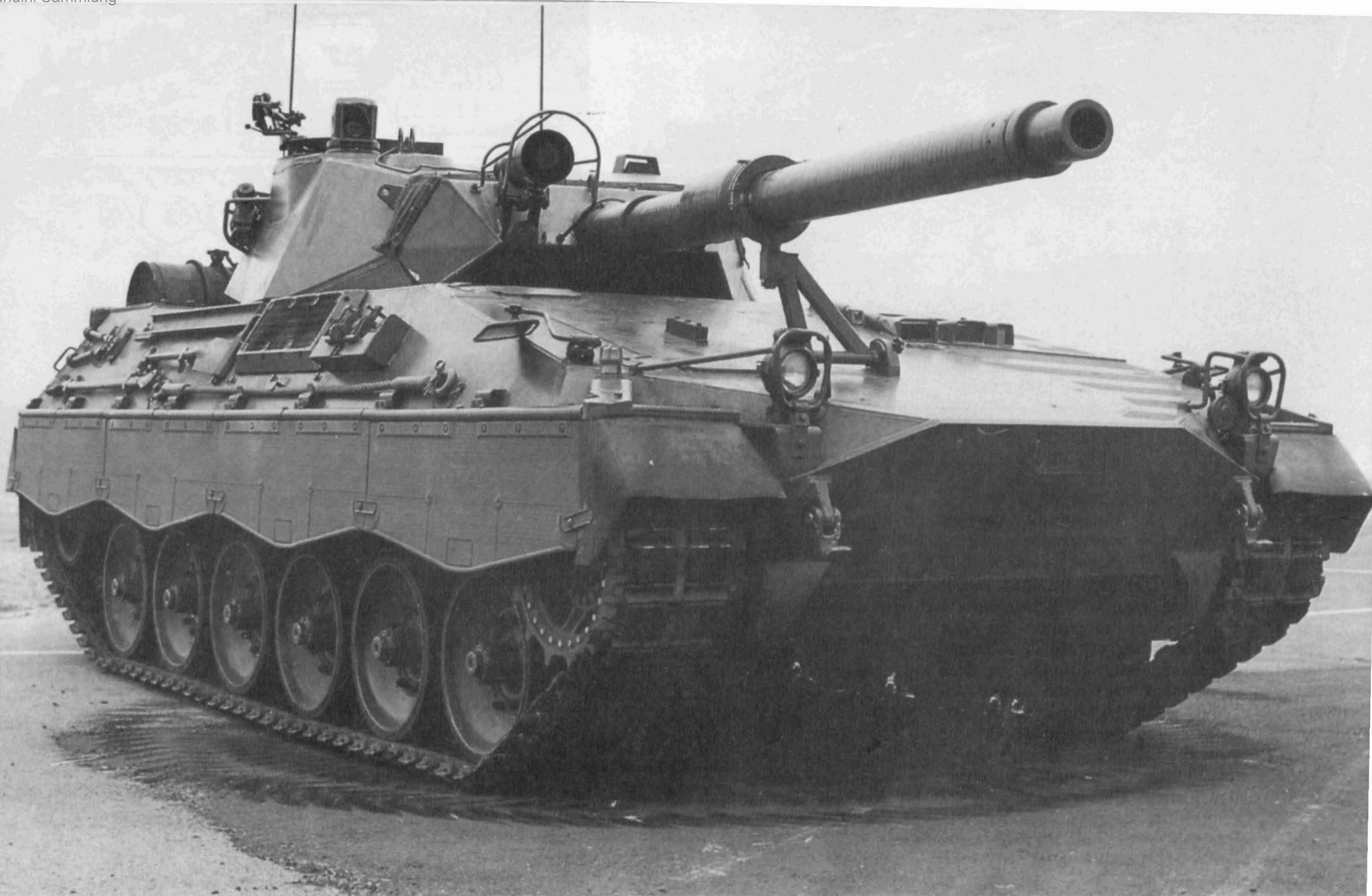
Der Kampfpanzer TH 301 wurde auf der gleichen Basis wie der KPz TAM entwickelt, ist jedoch mit einer zweiachsstabilisierten 105 mm-Kanone bestückt und besitzt ein voll integriertes Feuerleitsystem, mit dem selbst aus der Fahrt der Feuerkampf gegen fahrende Ziele geführt werden kann. Durch das leistungsstärkere Triebwerk (551 kW) erzielt das 31 t schwere Fahrzeug das gleiche Leistungsgewicht wie der KPz TAM.
