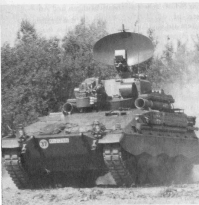
ROLAND II aus der Serienfertigung: Werferarme und Parabol-Cassegrainantenne des Feuerleitrads in Marschstellung. (Jahrbuch des Heeres 9)
