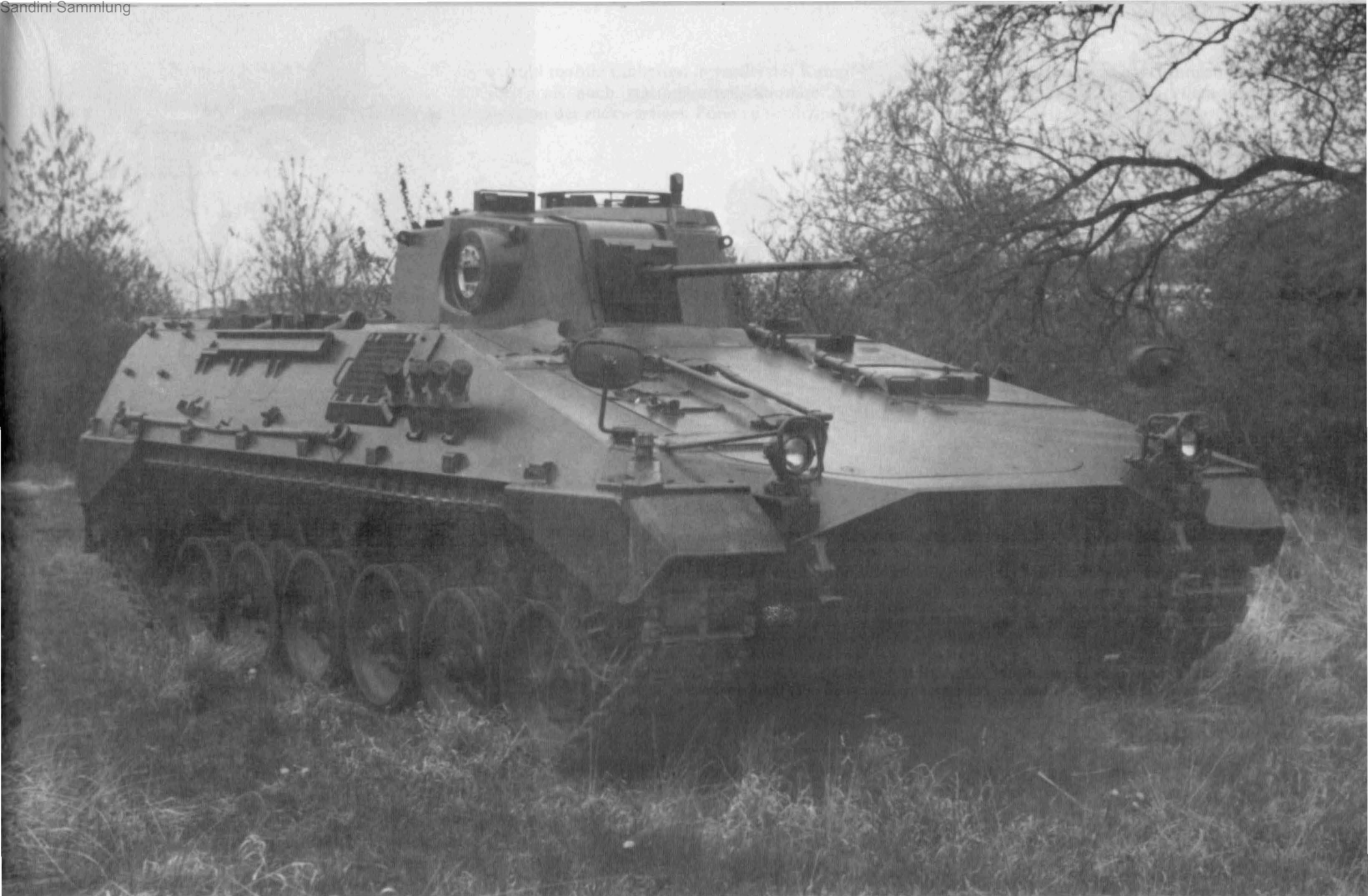
Äußerlich vom SPz VCTP nicht zu unterscheiden – der SPz TH 302. Er basiert ebenso wie der KPz TH 301 auf bewährten Baugruppen und Komponenten. Beide Fahrzeuge haben daher die gleiche Logistik. Durch das leistungsstärkere Triebwerk erzielt der TH 302 das günstige Leistungsgewicht von 20,4 kW/t.
