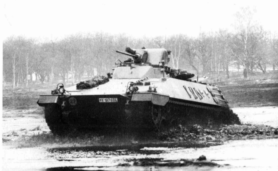
Schützenpanzer – neu der Nullserie; die Nebelwurfbecher befinden sich noch an der linken Turmseite, die Formgebung der Scheitellafette des Heck-MG's entspricht noch nicht der späteren Serienfertigung.
