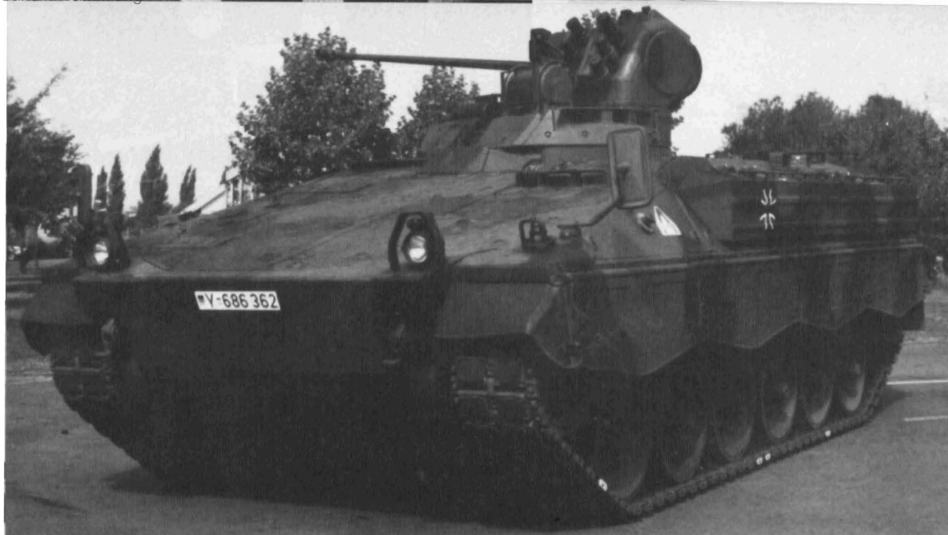
Dreiachsstablisierter Leichter Waffenturm (LWT 3) auf MARDER-Fahrgestell; ein interessantes und technisch aufwendiges Vorhaben – imponierend die niedrige Silhouette.
