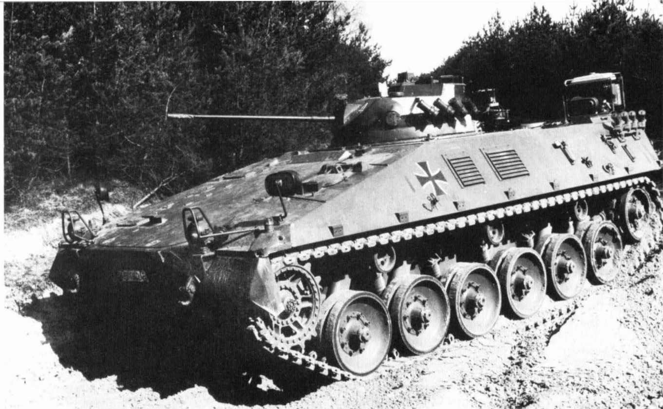
SPz MARDER mit 3-achs-stabilisiertem "Leichten Waffenturm" (LWT-3).
