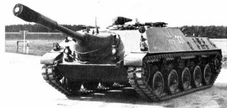
1966/67 wurden 710 Jagdpanzer, Kanone (Bordkanone 90 mm L 40,4 / 500 PS-Mehrstoff-Vorkammer-Dieselmotor MB 837 Aa) hergestellt.
