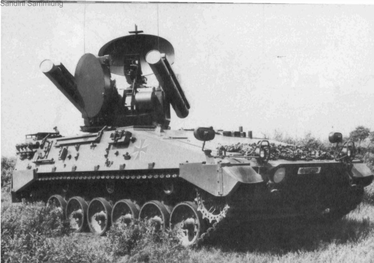
Vorserienfahrzeug des FlaRakPz ROLAND II, der Allwetterversion mit kreiselstabilisierter Parabol-Cassegrainantenne für das Feuerleitradar zwischen den beiden Werferarmen. Im Unterschied zum Serienfahrzeug fehlen u. a. die Kettenschürzen und die seitlichen Staukästen.
