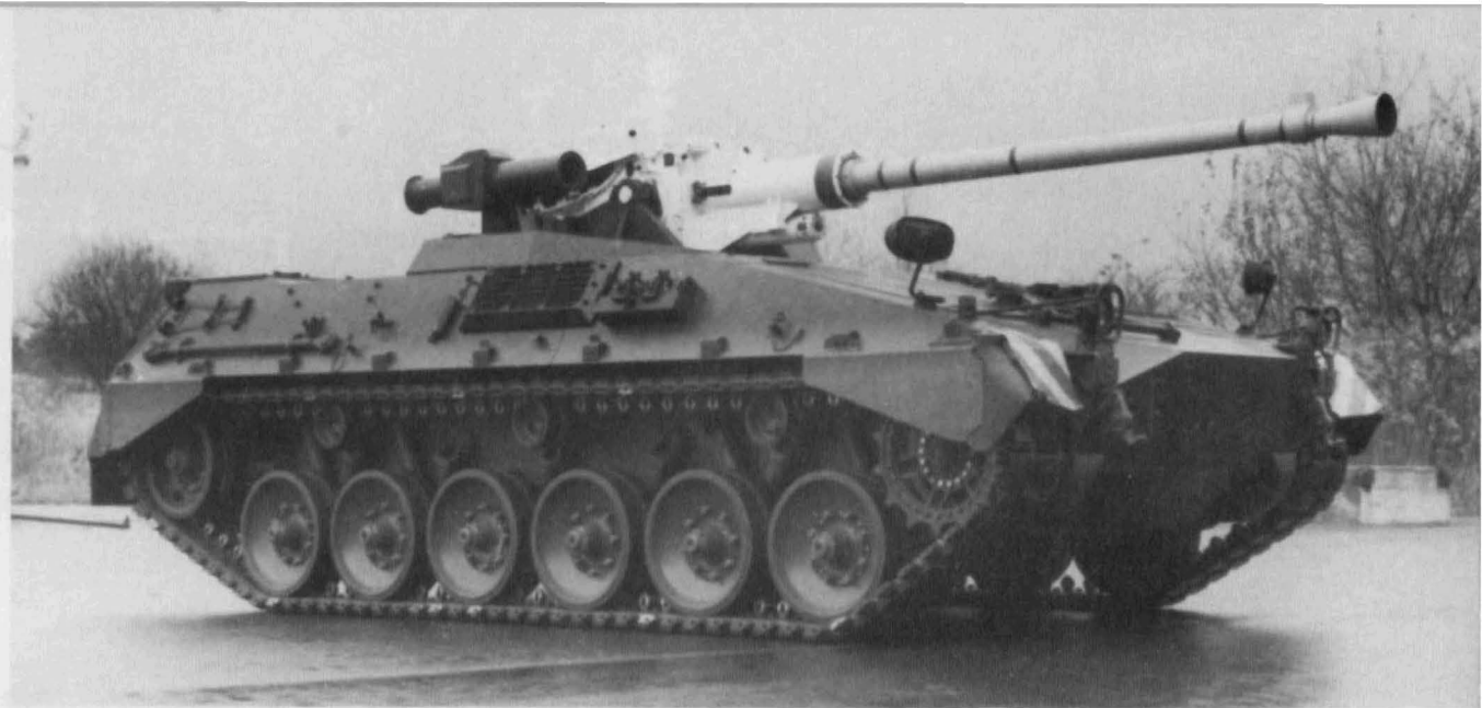
Fahrgestell und Fahrzeugwanne der neuesten Version des Begleit-Pz. 57 mm sind bis auf Turmaufnahme, Mannschaftsluken und Inneneinrichtung des Kampfraumes mit dem SPz MARDER identisch. Sein Gefechtsgewicht beträgt 30 t, sein Leistungsgewicht 14,7 kW/t bei einem Bodendruck von 0,85 daN/cm.
