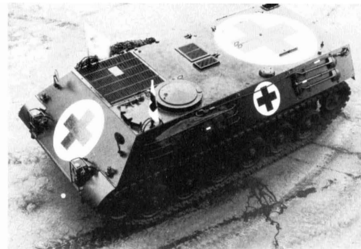
Prototyp 2 HK 2/2, SPz Krankenkraftwagen der Fa. Henschel (1960 – 1963). Die Entwicklung dieses Fahrzeugs wurde nicht weiterverfolgt, da auch für diese Zwecke der MTW M 113 eingesetzt werden konnte.
