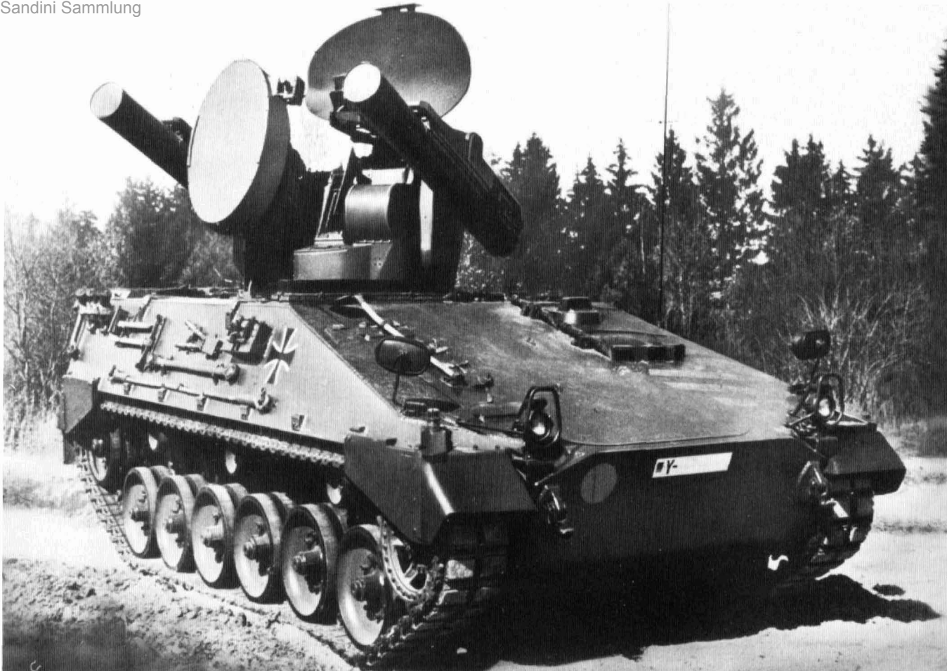
Versuchsträger FlaRakPz ROLAND I (Klarwettersystem), eine Entwicklung, die nur in Frankreich auf dem Fahrgestell AMX 30 in die Serienfertigung mündete.
