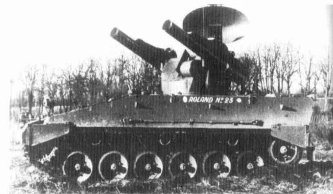
Versuchsträger FlaRakPz ROLAND I (Klarwettersystem), eine Entwicklung, die nur in Frankreich auf dem Fahrgestell AMX 30 in die Serienfertigung mündete.
