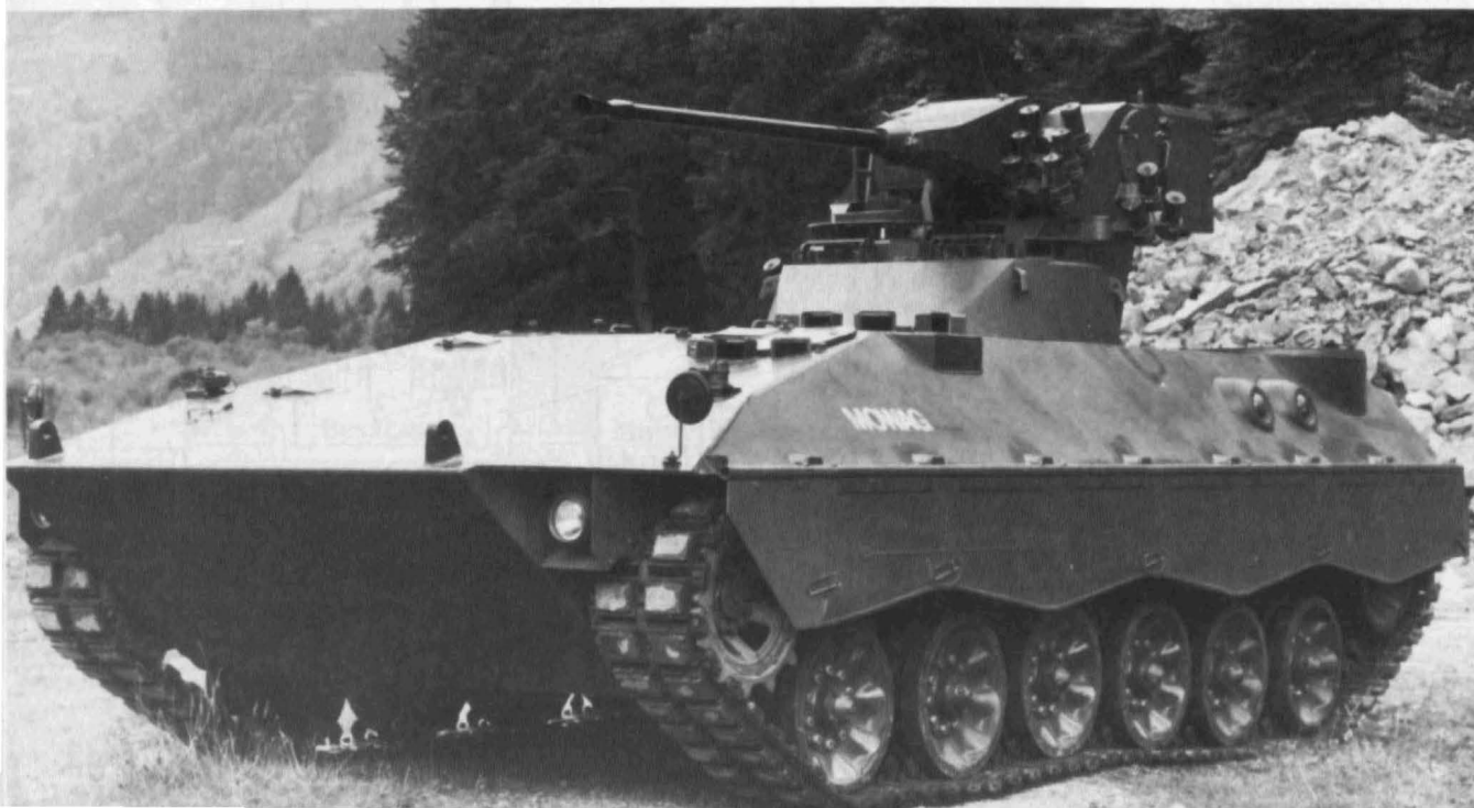
Oben links: Eine Zeitlang wurde erwogen, den Kampfwert des SPz MARDER mit einer 25 mm-Kanone und Zusatzpanzerung zu steigern. Die Zusatzpanzerung wurde durch Schraubverbindungen adaptiert, das Waffenträgergehäuse zur Aufnahme der größeren Waffe neu konstruiert, durch Verlegung eines Kraftstofftanks Raum für ein Ringmagazin geschaffen und Staubkästen an den Wannenseiten angebracht. Diese Lösung befriedigte jedoch den Bedarfsträger noch nicht; das Vorhaben "Kampfwertsteigerung SPz MARDER" wurde erneut in die Konzeptphase verwiesen.
