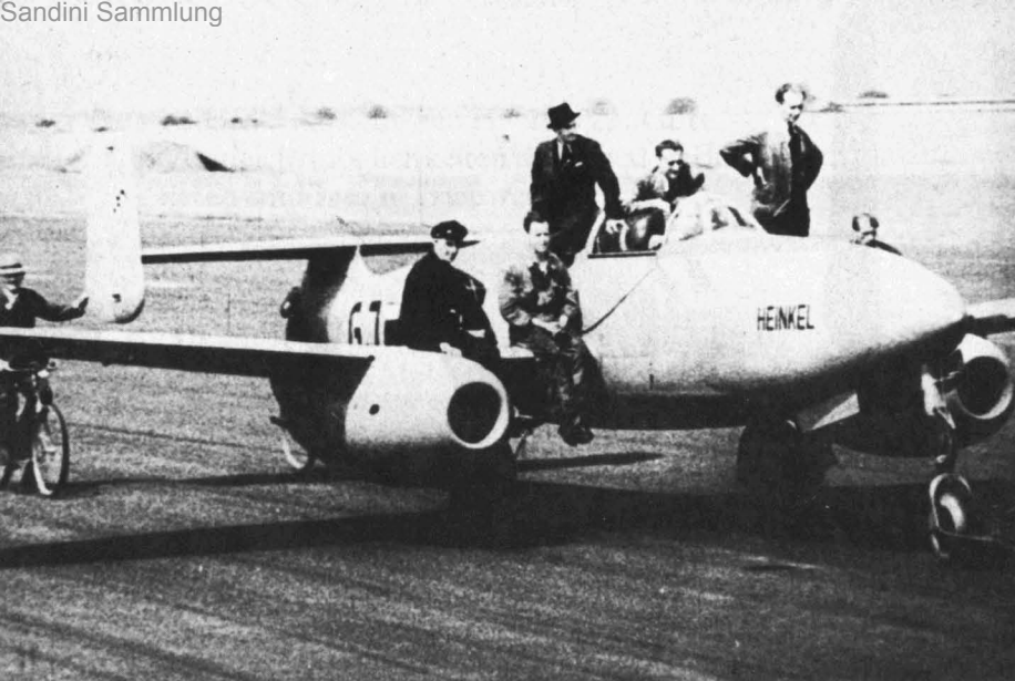
Ansicht des Schleppzuges von vorne. Gut erkennbare Details des Bugrads und die Schleppgabel, welche auch zur Lenkung benutzt wurde.
