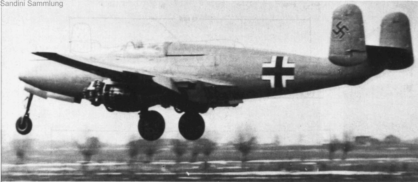
Oben: Start der He 280 V2 noch ohne Triebwerksbleche. Diese Maßnahme sollte einer Brandgefahr durch herabtropfenden Treibstoff auf die Verkleidung vorbeugen.
