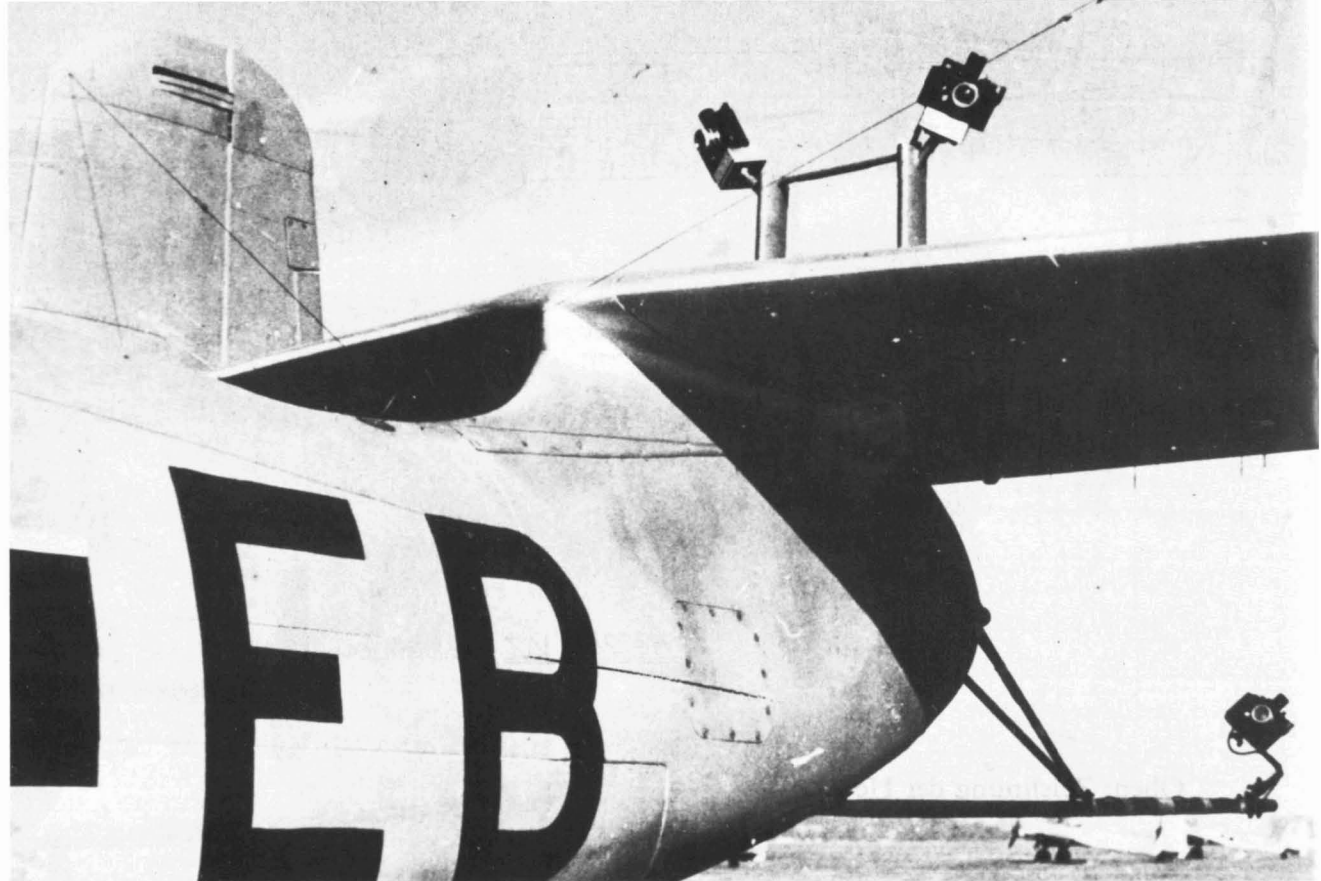
Foto der angebauten Kameras für den Abkippsversuch.
