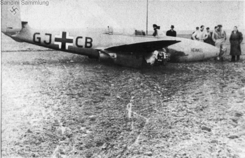
Bedingt durch einen Triebwerksbrand mußte die He 280 V3 am 8. 2. 1943 notlanden.
