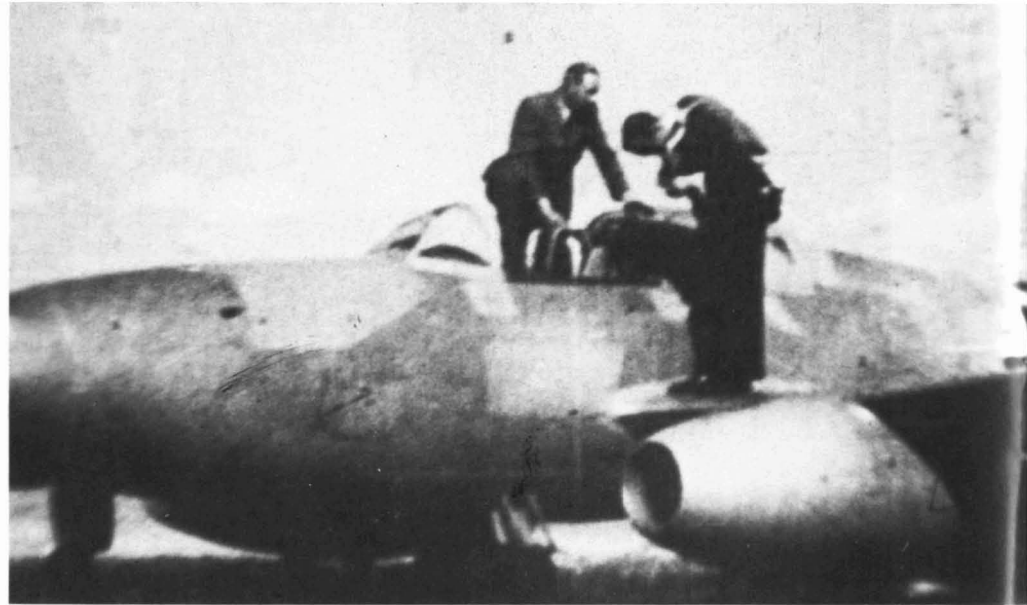
He 280 V2, noch ohne Schutzanstrich. Deutlich erkennt man die Blechstöße. Die verschiedenen Färbungen kommen durch verschiedene Metalle zustande.
