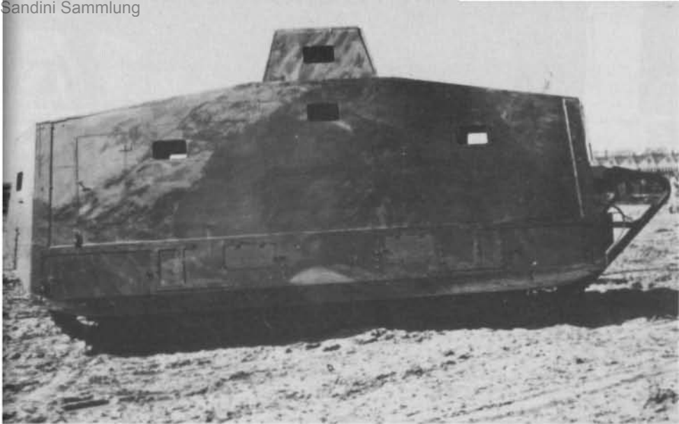
Oben: Der am 16. 1. 1917 bei Daimler, Marienfelde, fertiggestellte Holzaufbau, hier – im Mai 1917 – bereits auf das Prototyp-Fahrgestell gesetzt. Beachte den Gitterschnabel am Bug. Die spätere Anordnung der Türen, Klappen und Luken ist schon hier eingehalten.
