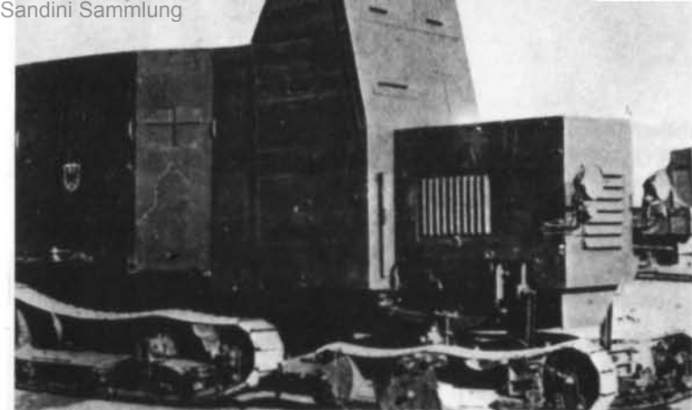
Oben: Ein Fahrgestell des Marienwagens I wurde überpanzert. Das überlastete Fahrzeug war nicht mehr ausreichend lenkfähig, da das vordere Gleiskettenpaar nicht angetrieben wurde.
