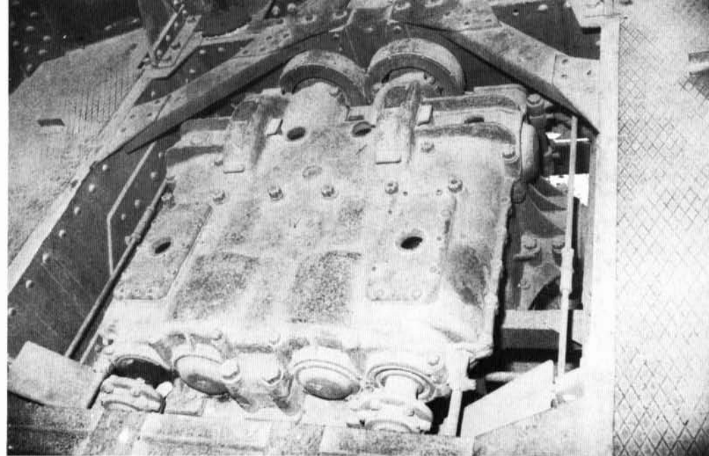
Der Getriebeblock eingebaut, hier in Wagen 506 "Mephisto". Die Abdeckplatte zum hinteren Kampfraum fehlt. Während beim Prototyp beide Bremstrommeln über ein Gestänge synchron bedient wurden, hatte das Produktionsmodell für jede Bremstrommel ein eigenes Gestänge, hier links und rechts vom Getriebeblock (mit Verdickung) zu sehen.
