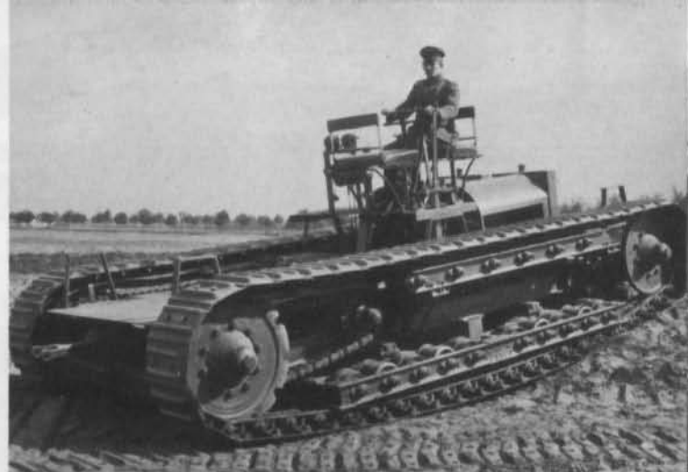
Oben: Der Dürwagen ohne Aufbau. Für einen gepanzerten Schutzaufbau erwies er sich als zu schwach.
