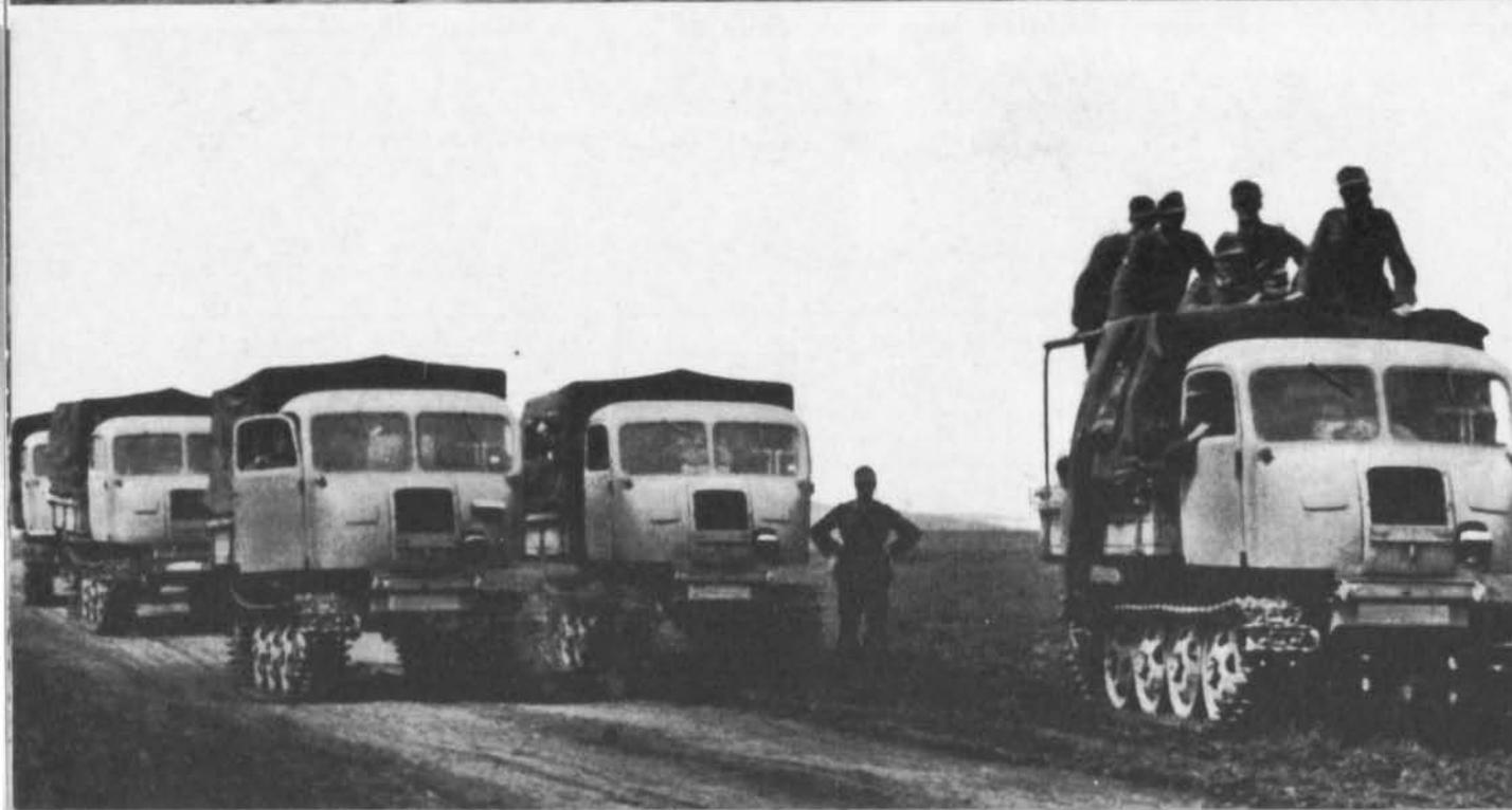
Der RSO kam im Frühjahr 1943 in großer Stückzahl an die Ostfront. Er besaß einen 3,5 l-Steyr-Vergasermotor, Leistung 70 PS. Gewicht 5.200 kg, Fahrbereich bei 180 Litern ca. 300 Straßen- oder 150 Geländekilometer.
