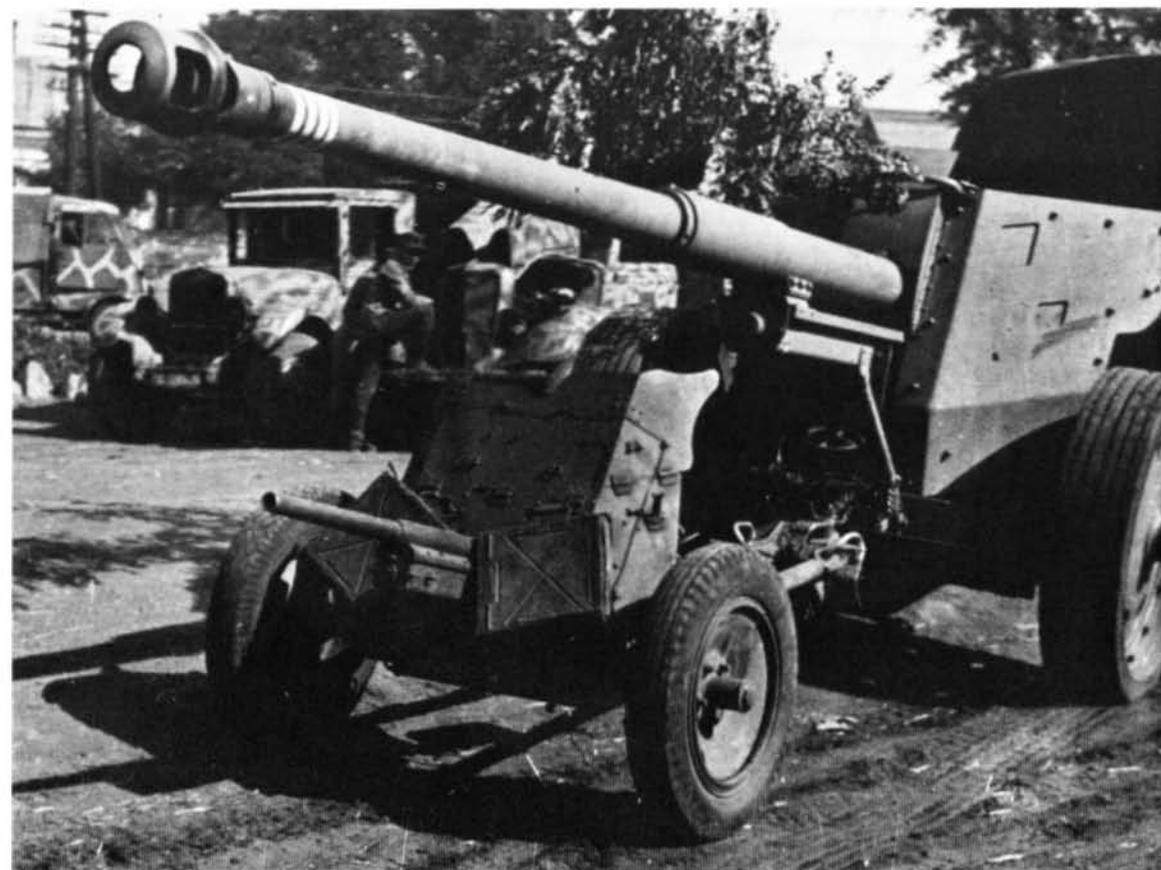
Dieses Foto einer 8,8 cm-Pak 43/41 L/71 mit einer Pak 35/36 gibt gut den Entwicklungssprung von innerhalb vier Jahren wieder. Die weißen Ringe am Rohr der 8,8 cm-Pak zeigen die Zahl der Panzerabschüsse an.
