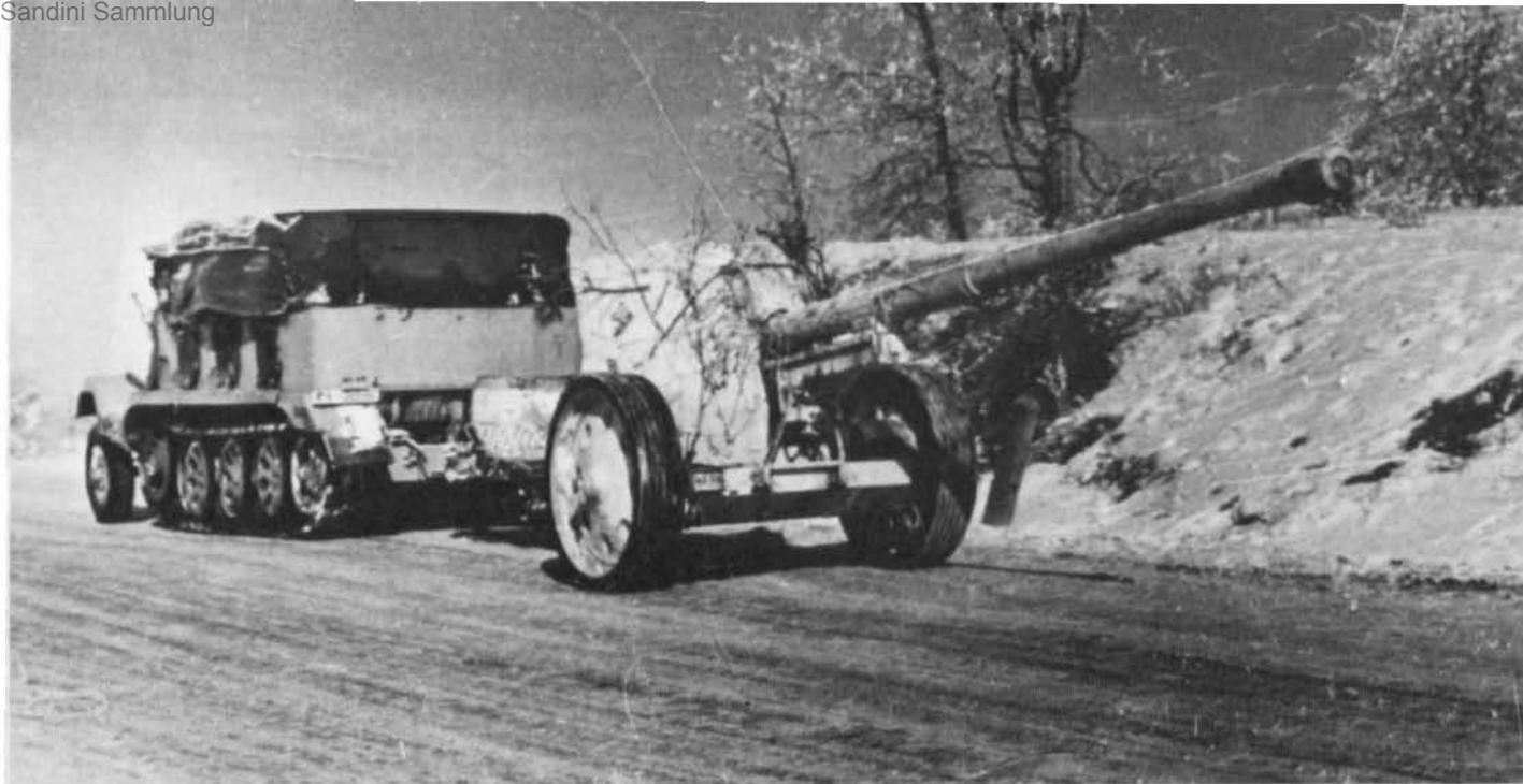
Das normale Zugfahrzeug für die 8,8 cm-Pak war die 3 t-Zugmaschine (Sd.Kfz. 10). Oben ein Bild aus Westdeutschland, Winter 44/45. Unten eine Aufnahme aus Ungarn (12. 1. 45).
