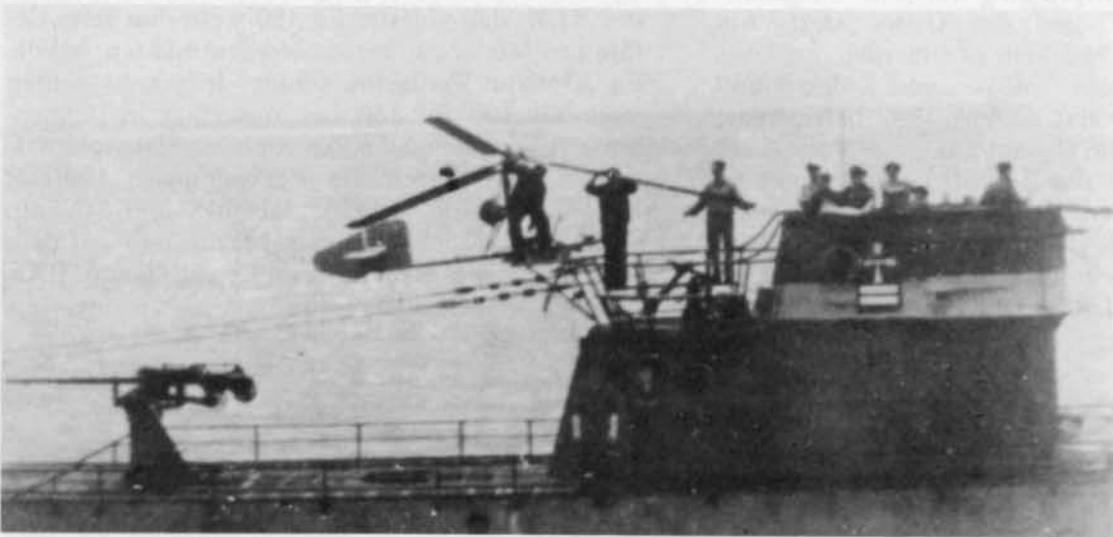
Die erste Erprobung einer Fa 330 während eines Versuchsfluges von einem U-Boot in der Nähe von Travemünde (1942).
