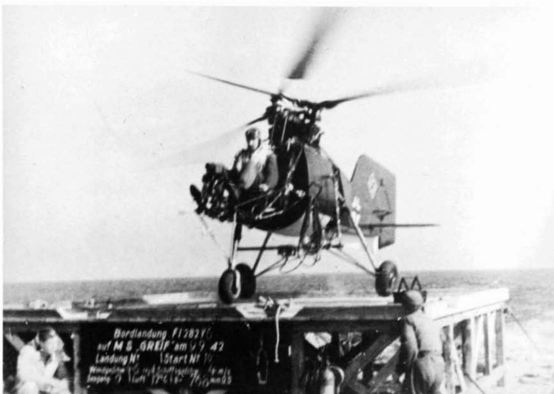
Landung der F1 282 V6 (GF+YF) auf dem Flugsicherungsschiff "Greif".
