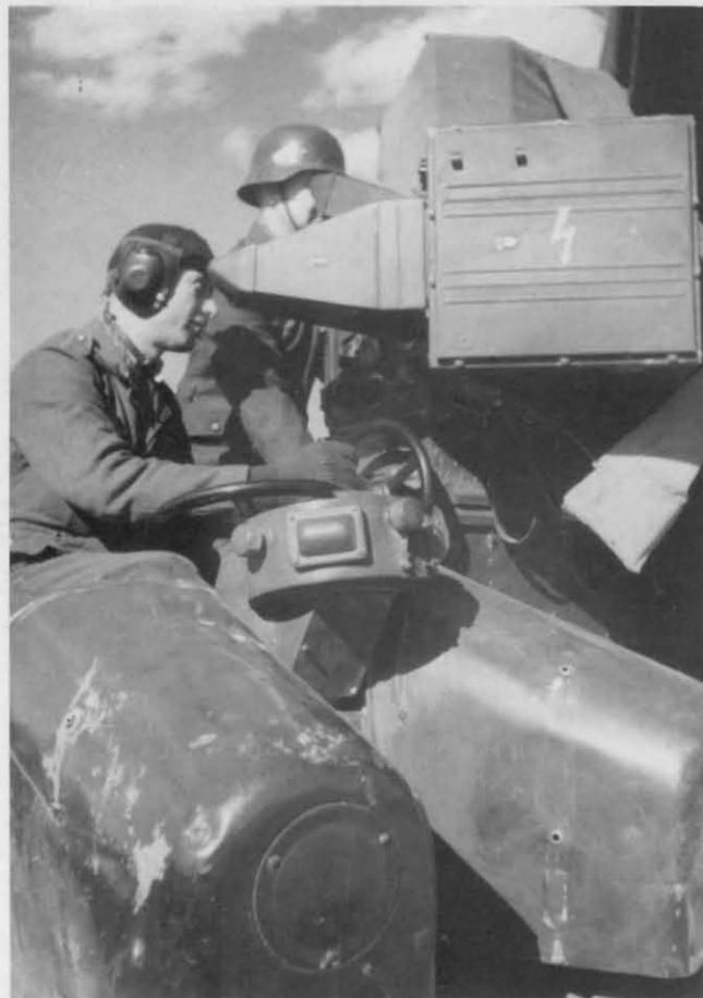
Oben links: Wir sehen vorn den B2 im Richtsitz, das Gerät der Seite nach schwenkend. Er schaut auf die vor ihm befindliche Entfernungs- und Seitenpeilanzeige. Hinter ihm steht der B3 am Betrachtungstabus der Höhenpeilanzeige und bedient das Höhenrichtrad am Geräteschrank.
