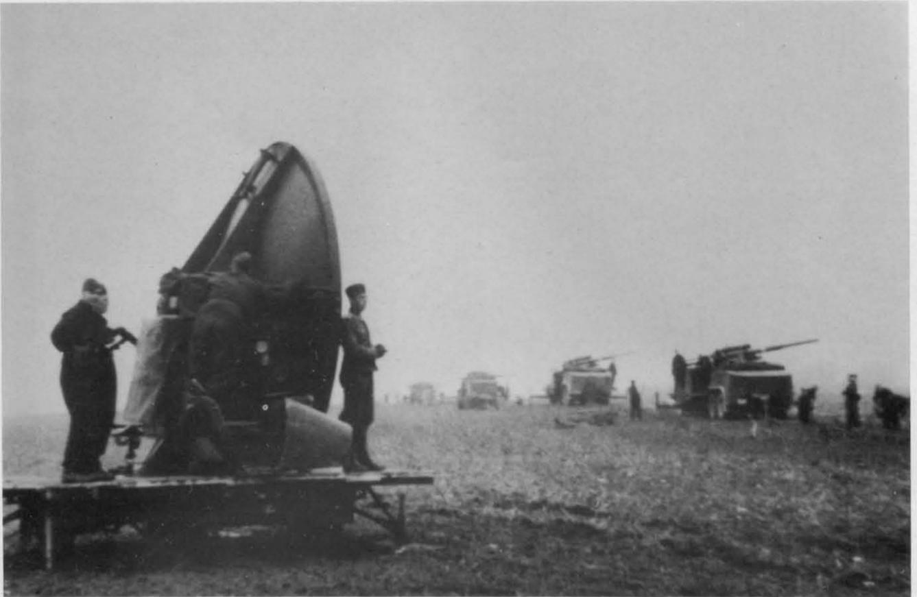
Oben: Dieses FuMG 39 T war der 2. Batterie der I./42 (mot.S.) zugeteilt, die hier deckungslos im Oktober 1941 bei Stettin in Stellung gegangen war. Die 8,8-cm-Geschütze dieser Flak-Abteilung waren als einzige in der Wehrmacht als Selbstfahrlafette auf VOMAG-Fahrgestelle verlastet.
