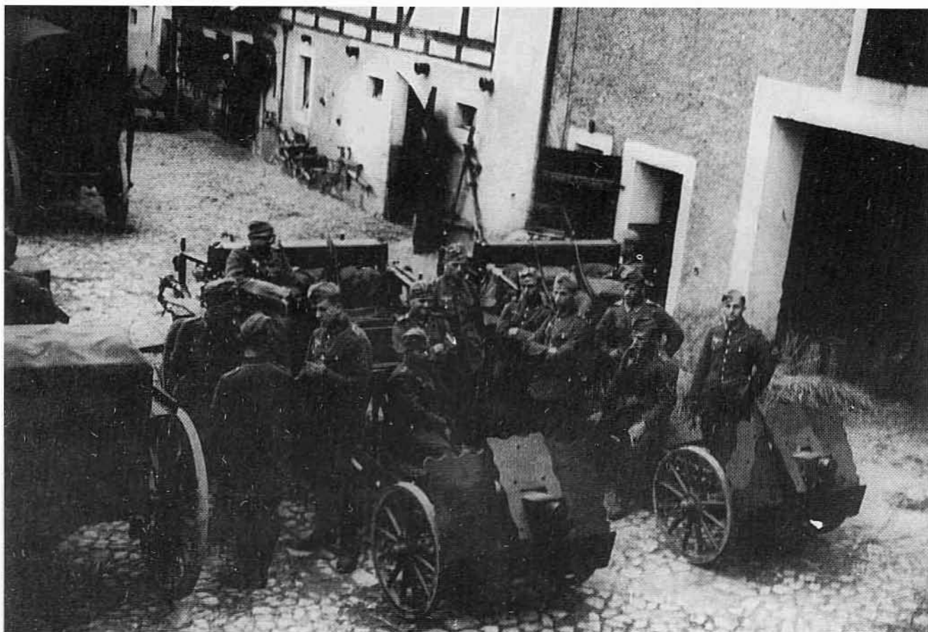
Zwei 7,5-cm leichte Infanteriegeschütze 18 mit den strukturmäßig vorgespannten Protzen für das 7,5-cm Infanteriegeschütz Itf. 12/1 (wurde auch für die 3,7-cm Panzerabwehrkanone genutzt). Links im Bild der Munitionswagen If. 12.
