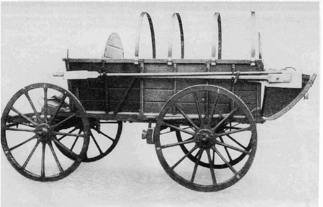
Als Abart des Hf. 1 lief der Leichte Feldwagen Hf. 1/1 mit einer gefederten Aufhängung des Wagenkastens.
