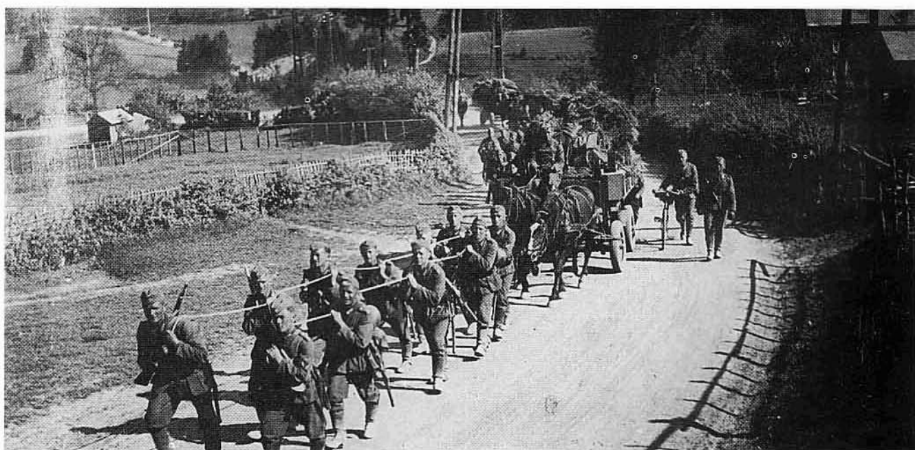
Eine weitere, in der H.Dv. nicht vorgesehene Art der Bespannung für den Hf. 7. Die durchschnittliche Zugbelastung des zweispännig gefahrenen Feldwagens lag für jedes Pferd bei 1,38 t. Erste Klagen gab es dazu bereits im September 1939 im Verlauf des Feldzuges in Polen. Unter den Bedingungen, wie sie ab 1941 in der Sowjetunion gegeben waren, steigerte sich die Kritik; der Hf. 7 stand in dem Ruf eines "Pferdemörders".
