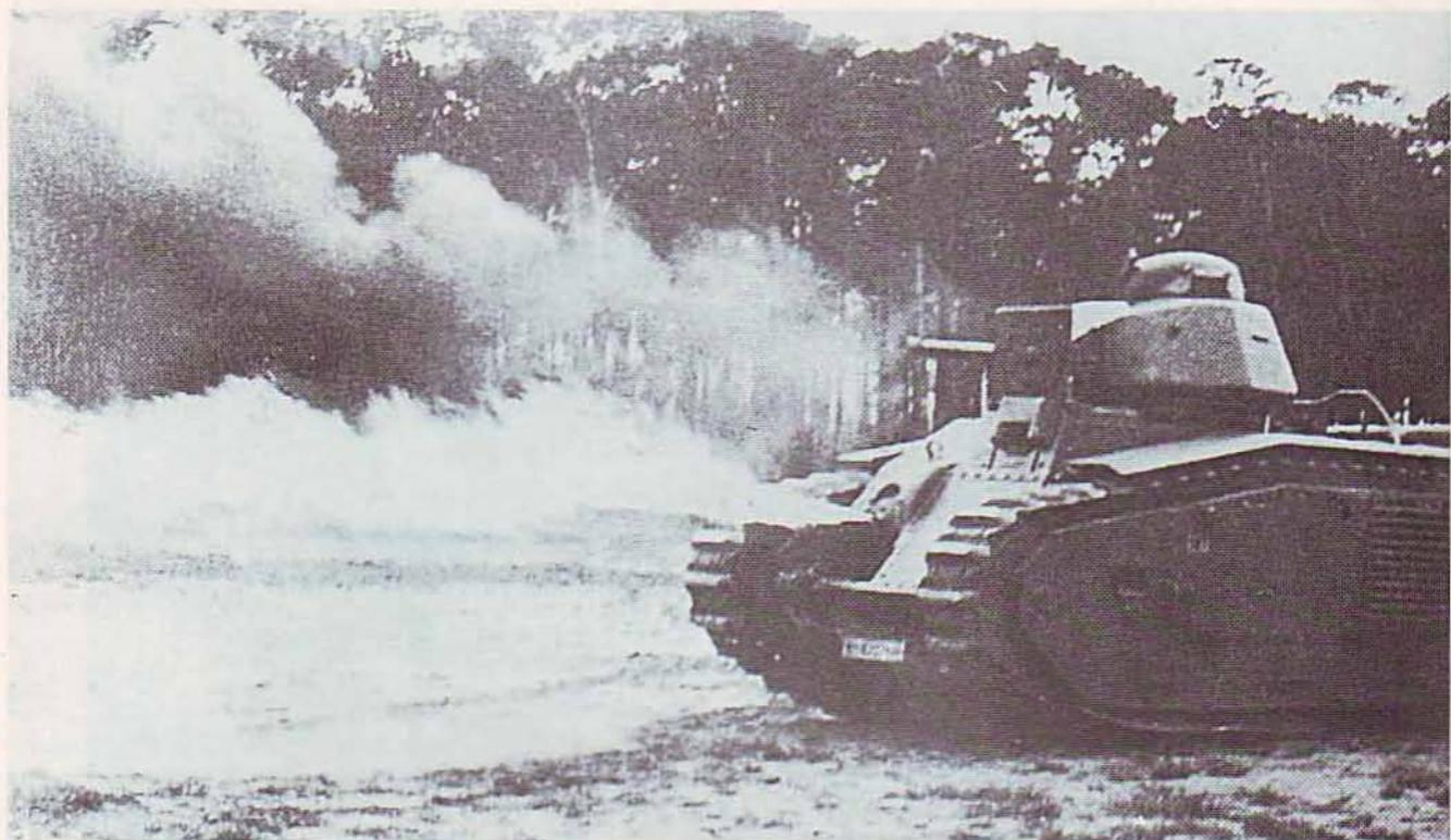
Vorführung eines der ersten mit Flammenwerfer ausgerüsteten "Char B 1". Bei der ersten Ausführung war nur die französische 75-mm-Haubitze durch einen Flammenwerfer ersetzt worden. Der Fahrer mußte gleichzeitig den Flammenwerfer bedienen, wobei das seitliche Schwenken des Fm. W. nur durch das Drehen der gesamten Panzerwanne erfolgen konnte. Der Kessel für das Flammöl befand sich rechts neben dem Fahrer im Fahrzeugbug (bei späteren Ausführungen wurde dieser am Fahrzeugheck befestigt).
