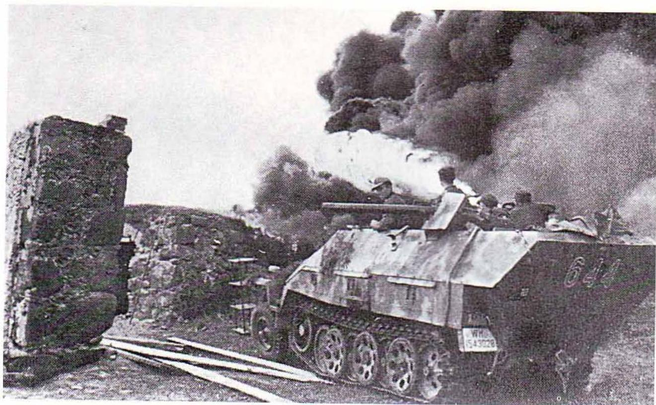
*Oben ein SPW der Ausführung D (glattes Heck), unten (Skizze) eine Ausführung C mit Flammenanlagen.*
