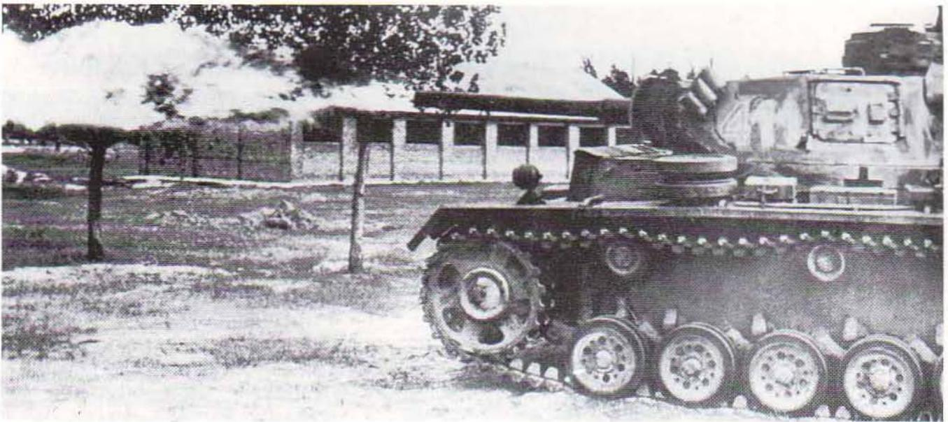
*"Panzerkampfwagen III (Fl) Sd. Kfz. 141/3" bei der Ausbildung von Flammgeschützen. Der Kommandant des Fahrzeuges wurde als Flammführer und der Richtschütze als Flammgeschütze bezeichnet. Der Fahrer war gleichzeitig der Flammwart. Insgesamt 100 dieser Flammpanzer III wurden von Ende 1942 bis Mitte 1943 hergestellt. (WJS)*
