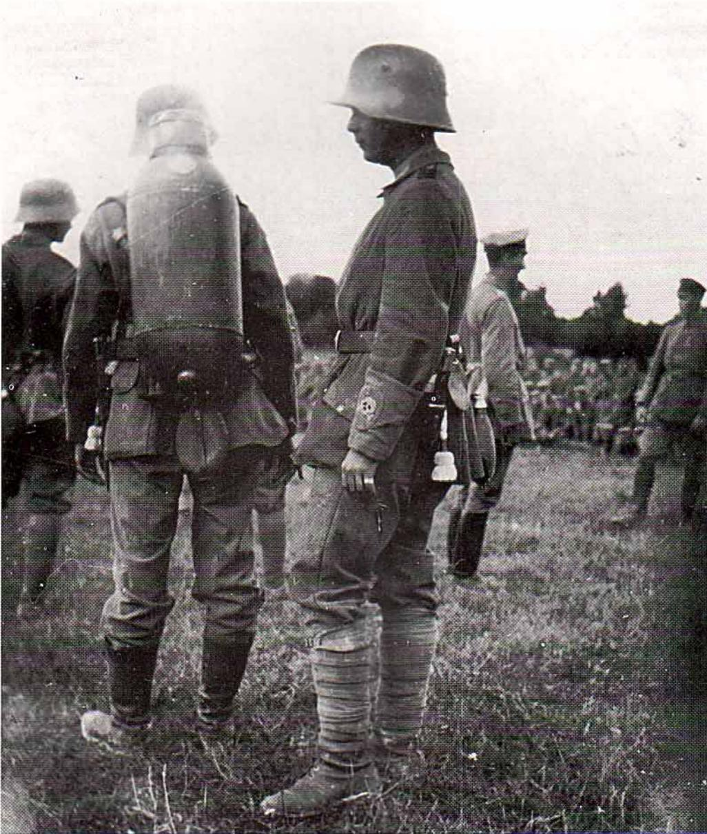
*Die ursprüngliche Ausführung des "Kleinen Flammenwerfers" hatte die Form eines Kessels. Der Stickstoffbehälter wurde entweder seitlich oder an der Rückseite befestigt. Die Aufnahme zeigt deutlich, daß dieses Gerät für Stoßtrupps zu schwer gewesen sein dürfte. Der Flamm-schütze trägt am Ärmel das Zeichen der Flammtruppe, den "Totenkopf". (WF)*
