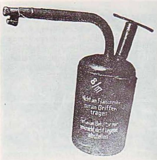
Soweit der "Abwehr-Flammenwerfer 42" auf dem Gefechtsfeld nicht mechanisch beschädigt oder zerstört wurde, konnte er jederzeit nachgefüllt werden. Dann wurden noch die Sprengscheiben sowie die Druckpatronen ausgewechselt, und das Gerät war wieder einsatzbereit.
