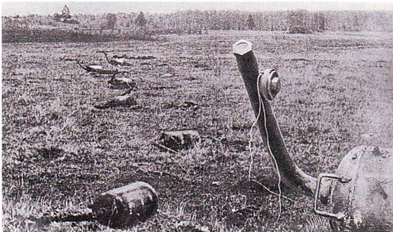
*Russische Flammenwerfer, die von deutschen Pionieren ausgegraben wurden. Alle brauchbaren Geräte wurden mit deutschen Druckpatronen, Zündern und Sprengscheiben ausgerüstet und wiederverwendet.*
