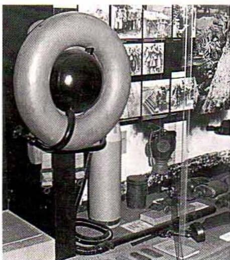
*Die endgültige Form des tragbaren Flammenwerfers. Er war deutlich kleiner. Der äußere Ring war der Flammölbehälter und in der Mitte befand sich halbkugelförmig der Behälter für den Stickstoff. Oben ein nachgebauter "Kl.Fm.W." in der Ausstellung des MHM Dresden.(GT)*
