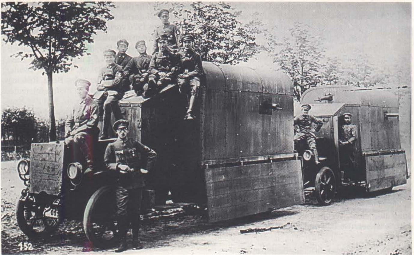
Zwei behelfsmäßig hergestellte Panzerwagen der Freikorpsstruppen auf Lastkraftwagen-Fahrgestellen. Der Gefechtswert solcher Fahrzeuge, bei denen in der Regel unvergütete Stahlbleche verarbeitet wurden, blieb gering. Ihre Existenz beförderte in der Reichswehr den Gedanken gepanzerte Radfahrzeuge zu beschaffen; ebenso wichtig war die Auswertung von Einsatzerfahrungen. (WF)
