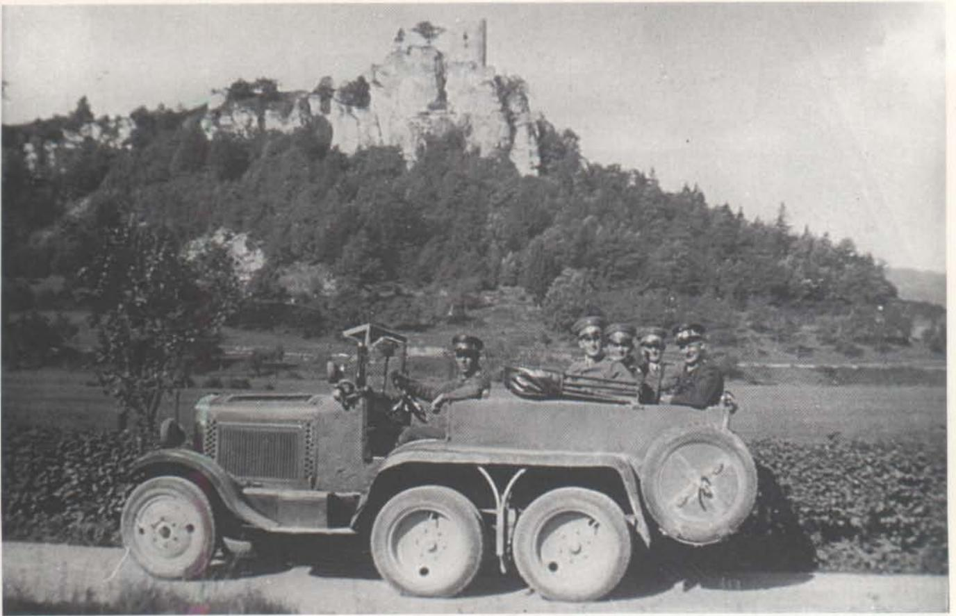
1926 beschaffte die Reichswehr eine kleine Zahl von Sechsrad-Geländewagen, darunter fünf Horch 8. Das Gesamtgewicht lag bei 4680 kg, ein 8-Zylinder-Horchmotor mit 80 PS Leistung kam zum Einbau, der dem Fahrzeug eine Geschwindigkeit von maximal 70 km/h verlieh. (CK)
