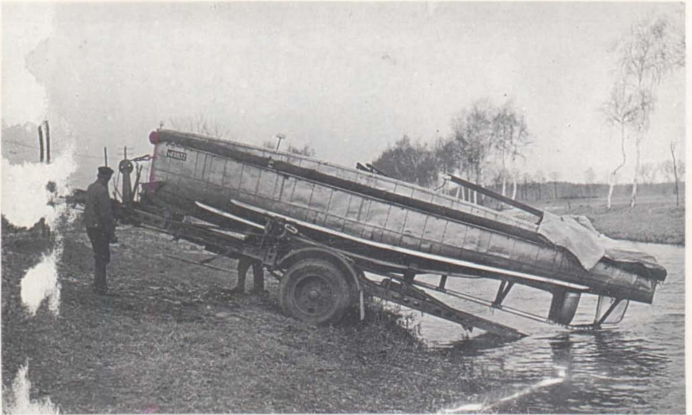
Bei den motorisierten und teilmotorisierten Pionierbrückenkolonnen verwendet wurde der Ah. 13 (=Anhänger einachs.) für Motorboot. Er besaß einen offenen Rahmenaufbau mit einer Vorrichtung zum Verladen und Zuwasserbringen eines Motorbootes. (WF)
