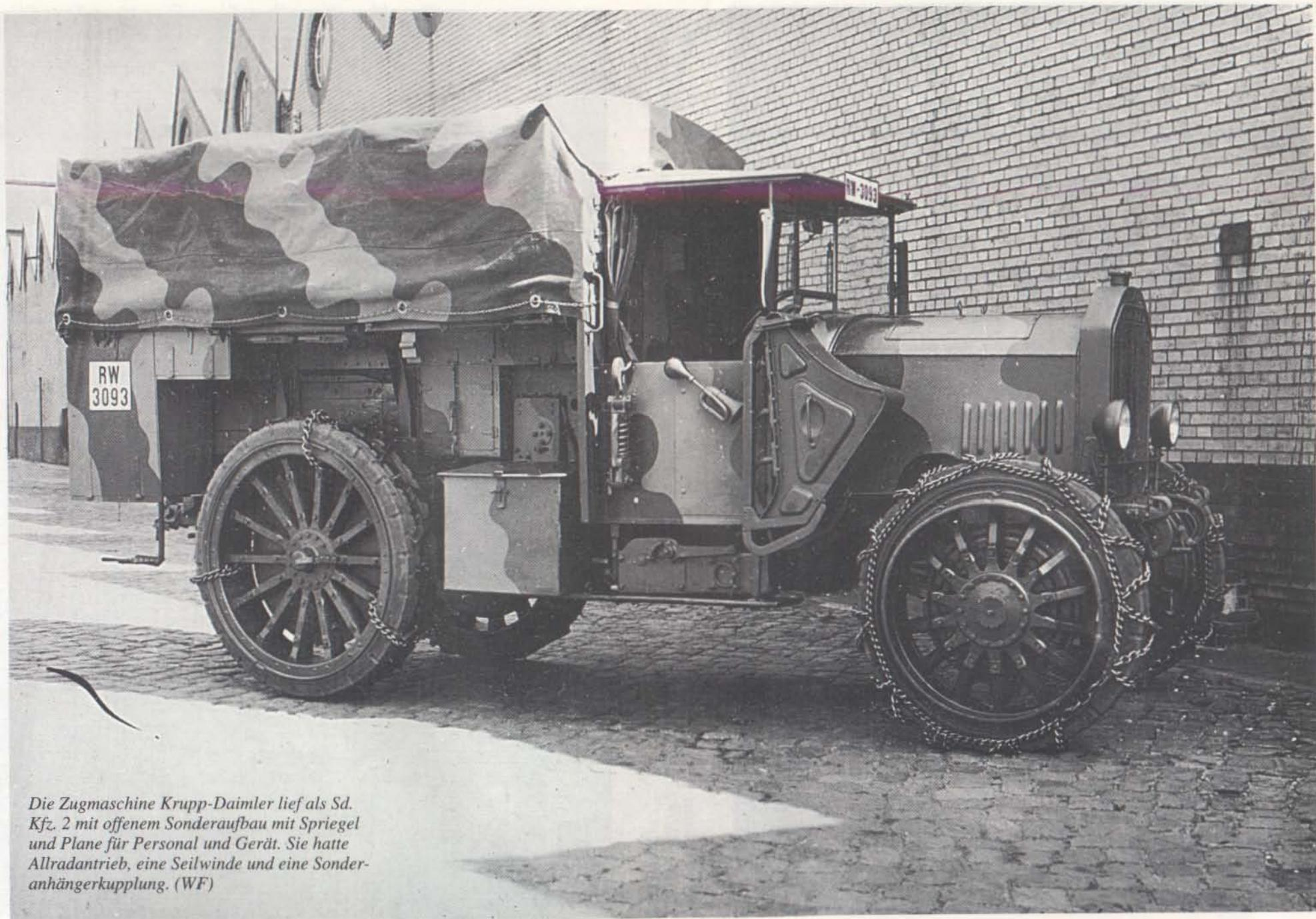
*Die Zugmaschine Krupp-Daimler lief als Sd. Kfz. 2 mit offenem Sonderaufbau mit Spriegel und Plane für Personal und Gerät. Sie hatte Allradantrieb, eine Seilwinde und eine Sonderanhängerkupplung. (WF)*
