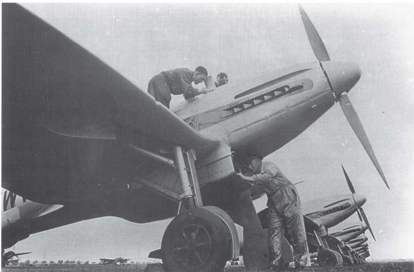
Oben: He 112 B-0, die für den Auslandsexport gebaut wurden. Unten: He 112 B-1, ebenfalls Exportmaschinen. Die Muster unterschieden sich äußerlich hauptsächlich in der geänderten Auspuffanlage.
