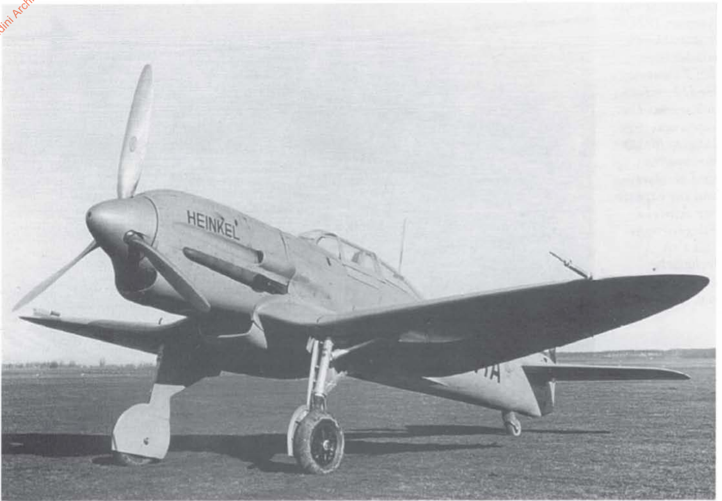
Durch die Ausrüstung mit einem DB 601-Motor verlor die Formgebung der He 112 V10 etwas an Eleganz, aber die Leistung des Musters war der Me 109 nun ebenbürtig.
