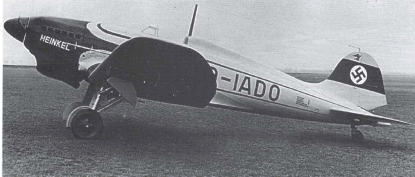
Die erste He 112, ausgerüstet mit einem Rolls-Royce "Kestrel" S II-Motor und nicht einziehbarem Kühler. Als Bewaffnung hätte die V1 lediglich 6x10 kg Splitterbomben mitführen können, MG's waren bei diesem Versuchsmuster noch nicht vorgesehen.
