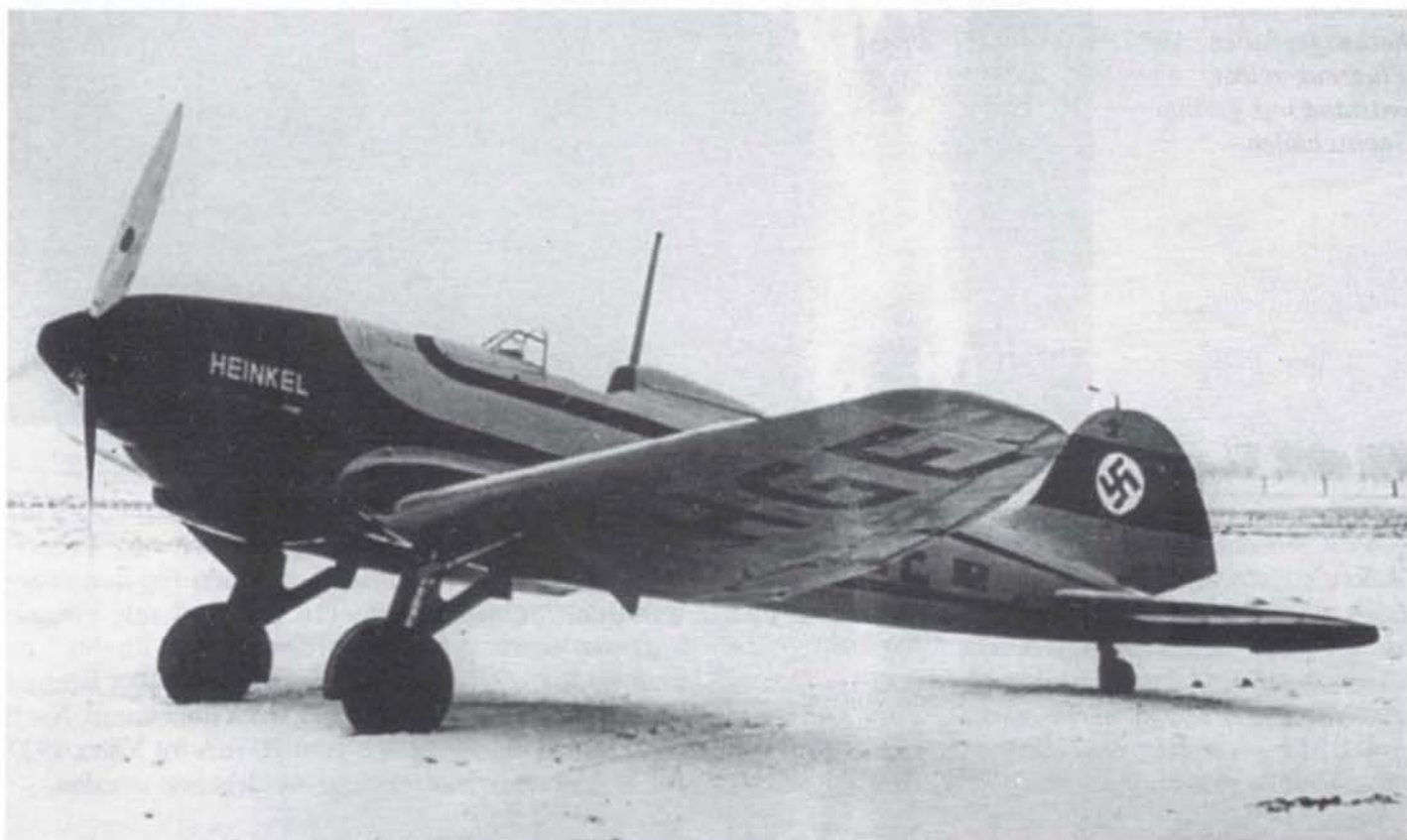
Die He 112 V2 war bereits mit einer durch die Propellernabe schießenden 2 cm-Motorkanone des Typs MG C/30 L ausgerüstet.
