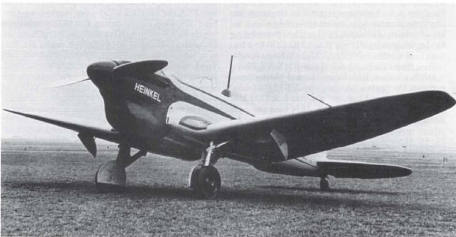
Unten: Die VI ist komplett fertiggestellt und bemalt. Den starren Zweiblatt- Holzpropeller lieferte die Firma HKW (Heiden- heimer Kupferwerke, Frankfurt am Main).
