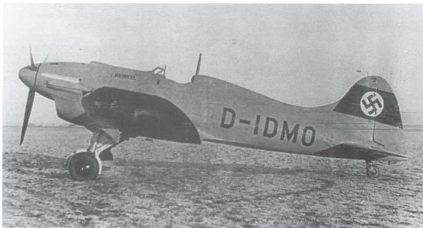
Die für 3 MG 17 (7,92 mm) ausgelegte He 112 V3 D-IDMO. Das Flugzeug war im März 1937 als für "Sonderaum Künzel" (Raketenantriebsversuche) geliefert gemeldet.
