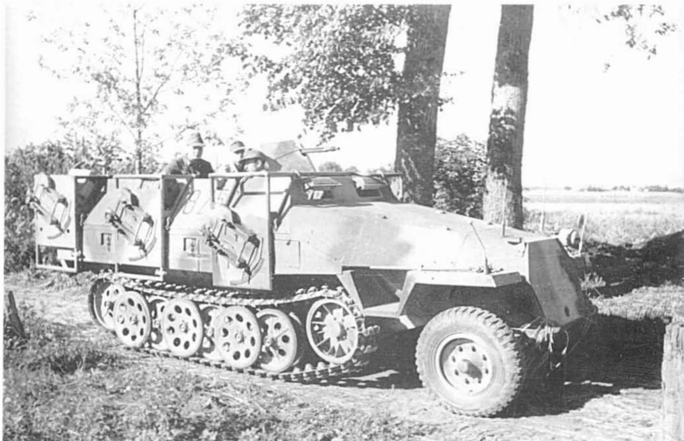
*Diese Aufnahme aus dem Jahr 1944 zeigt einen mittleren Schützenpanzer HL Kl 6 p (Sd. Kfz. 251) der D-Ausführung mit dem schweren Wurffrahmen. Gut zu erkennen ist die bewegliche Aufhängung für die Packkisten der Wurfkörper. (BA)*
