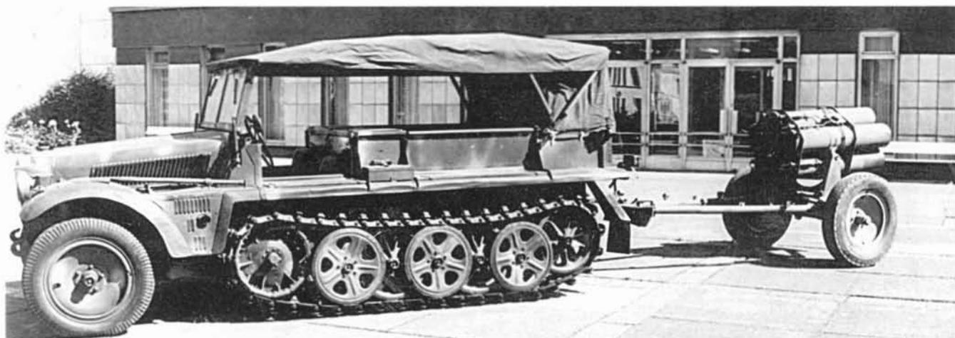
Als Zugmittel für den 21 cm-Nebelwerfer 42 kamen der leichte Zugkraftwagen 1 t (Sd. Kfz. 10) (im Bild) und der leichte Zugkraftwagen 3 t (Sd. Kfz. 11/5) zum Einsatz.
