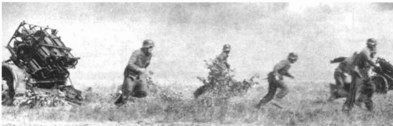
*Eine Batterie 28/32 cm-Nebelwerfer 41 unmittelbar vor der Feueröffnung. Die Bedienungen begeben sich in Deckung. Innerhalb von fünf Minuten konnten zwei Salven zu je sechs Schuß abgegeben werden.*
