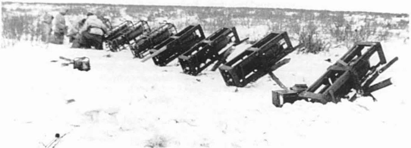
28 cm-Wurfkörper Spreng werden zum Abschluß vorbereitet. An Stelle der schweren Wurfgeräte 40 (Holz) und 41 (Stahl) sind die Packkisten auf behelfsmäßigen Gestellen aufgelegt. Verwendet werden Packkisten aus Holz und Stahl. (BA)
