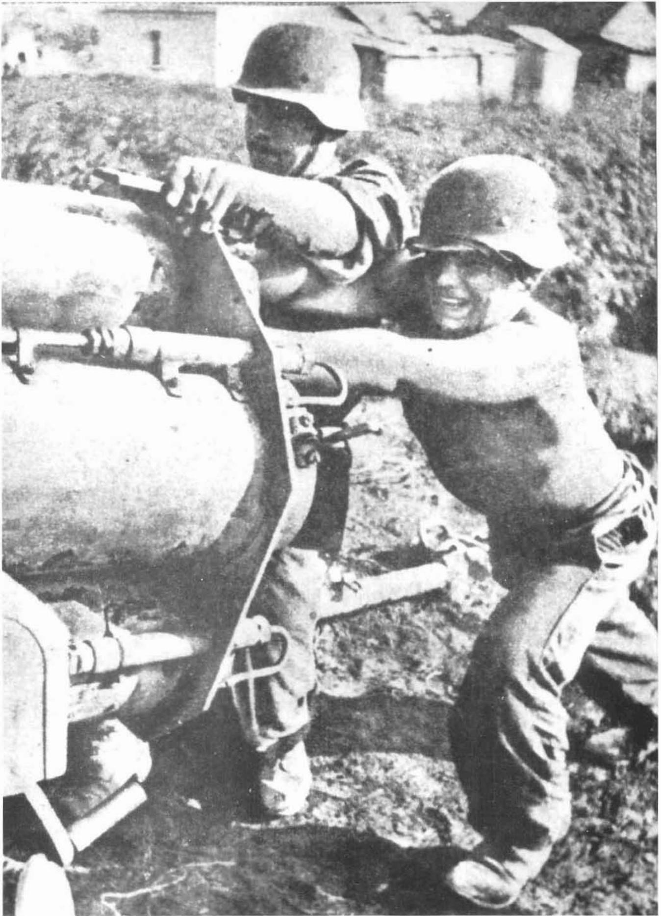
Ein 21 cm-Nebelwerfer 42 wird geladen. Es kostete erhebliche Anstrengungen, um die fünf 110 Kg schweren Geschosse in die Rohre des Wefers zu schieben.
